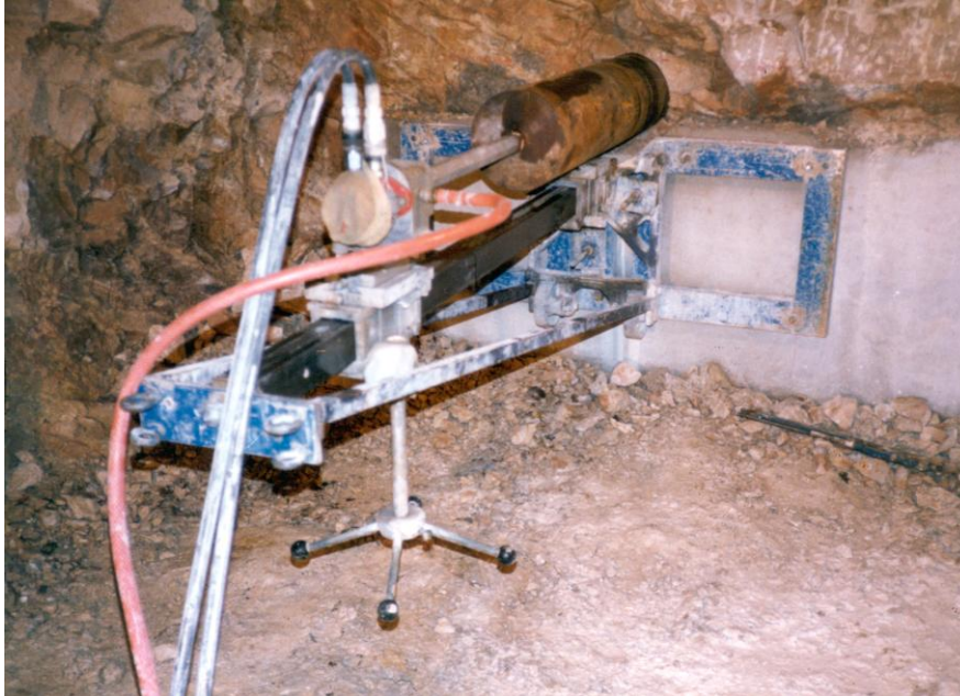
Slika 17. Bušenje centralne bušotine za horizontalni pokus (Karun 3, 1993)
