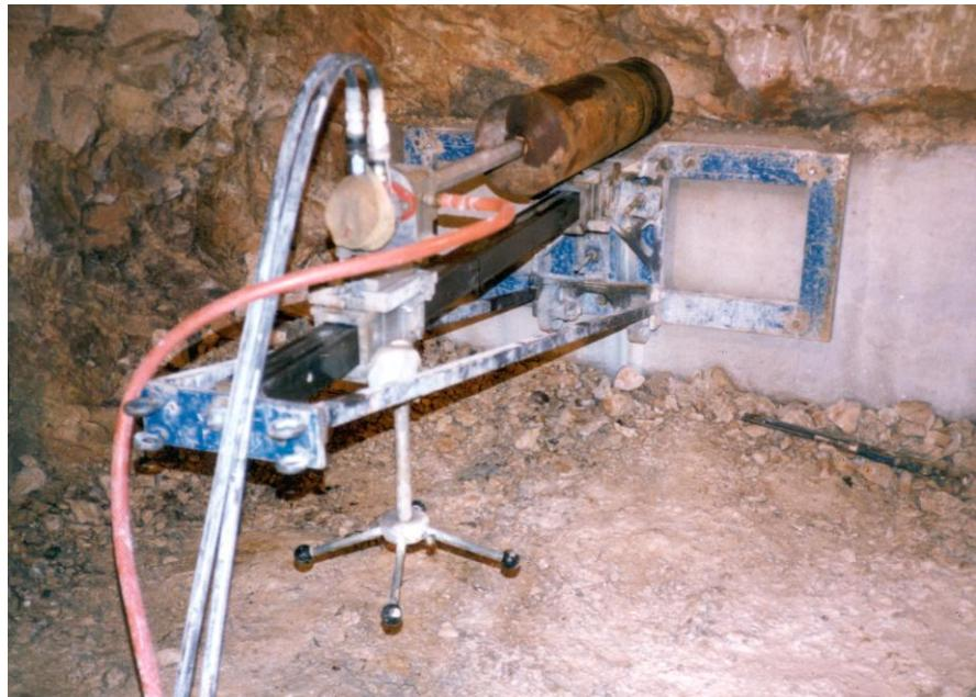
Slika 17. Bušenje centralne bušotine za horizontalni pokus (Karun 3, 1993)
