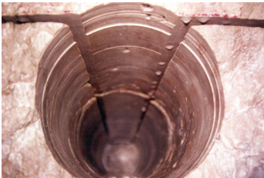
Slika 15. Fotografija stijenki bušotine (vidi se izrezani prorez)
