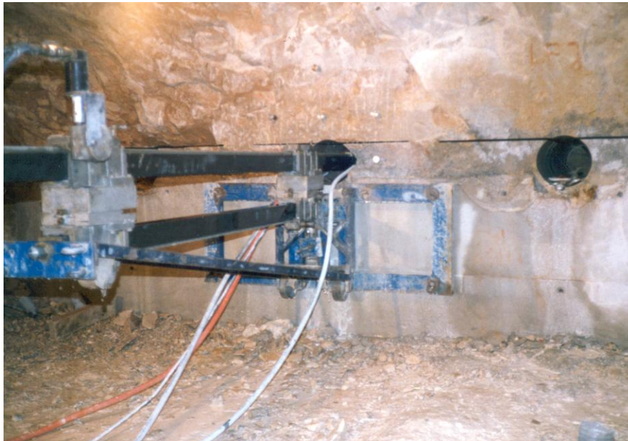
Slika 19. Rezanje srednjeg (aktivnog ) proreza. Pasivni prorezi su izrezani. Vide se i reperi za mjerenje pomaka na površini iskopa (Karun 3, 1993).
