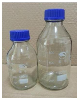
**Slika 18.** Sterilne bočice za uzorkovanje [22]
