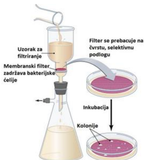
Slika 19. Postupak membranske filtracije [23]
