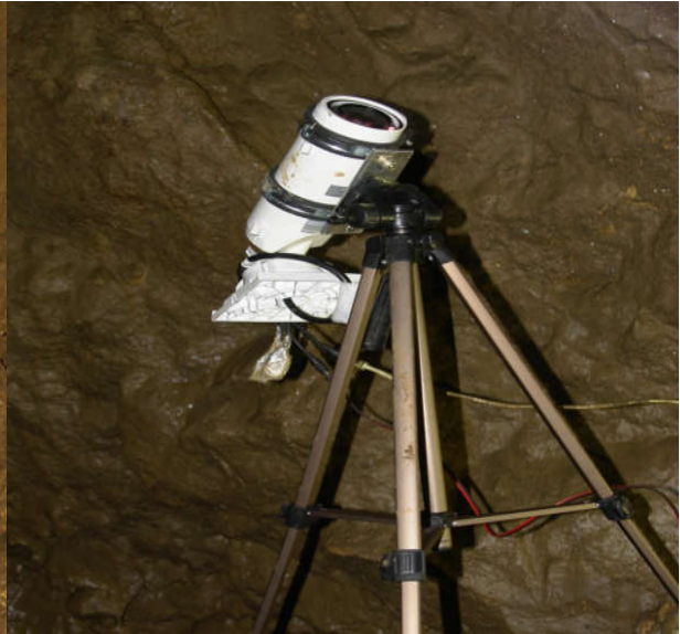
Slika 6.4 Sustav snimanja infracrvenom kamerom
