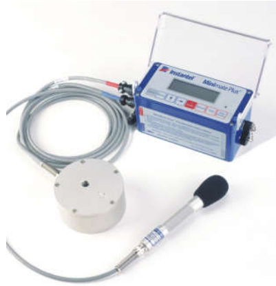
Slika 3.7 Seizmograf InstanTEL MiniMate Plus
