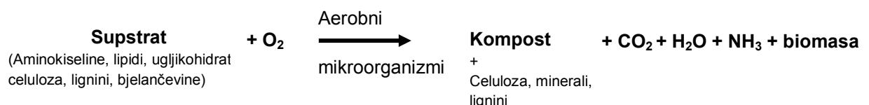
Proces kompostiranja podrazumijeva kontrolirane uvjete koji se postižu kontrolom vlažnosti materijala i temperature, aeracijom, mehaničkim miješanjem i sl. Ukoliko se proces ne provodi pod kontroliranim uvjetima te koncentracija kisika u kompostnoj masi padne ispod 10 %, dolazi do stvaranja anaerobnih uvjeta i pojave neugodnih mirisa ( $\text{H}_2\text{S}$ ). Kompostiranje se općenito može podijeliti u četiri faze (mezofilna, termofilna, faza hlađenja i faza zrenja).
