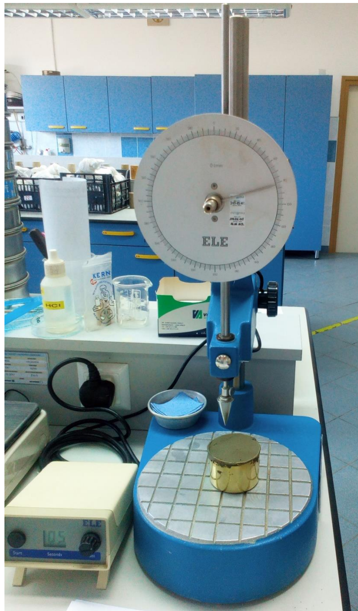
Slika 19. Određivanje granice tečenja pomoću konusnog penetrometra
