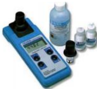
Slika 3. Turbidimetar za mjerenje mutnoće vode [5]
