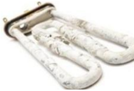
Slika 7. Talog na cijevima [28]
