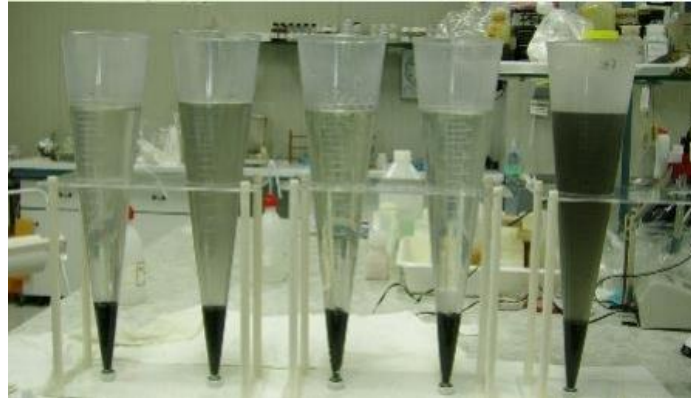
Slika 2. Imhoffov stožac za mjerenje raspršenih tvari u vodi [5]
