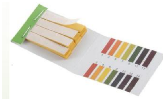
Slika 6. Lakmus papir za mjerenje pH vrijednosti [5]
