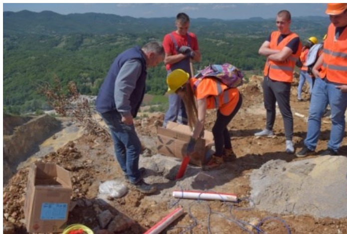
Slika 4.16. Punjenje minske bušotine eksplozivom.
