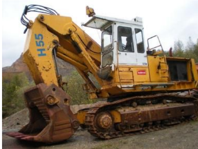
Slika 4.2 Hidraulički bager sa visinskom lopatom [14].
