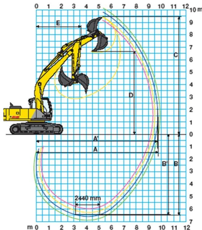
Slika 4.3 Hidraulički bager s dubinskom lopatom [15]
