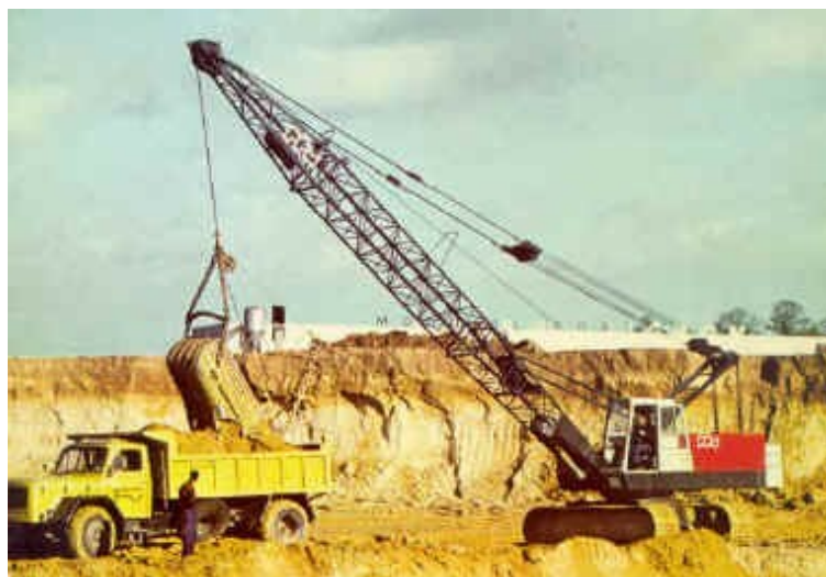
Slika 4.4 Skreperski ili povlačni bager [16]
