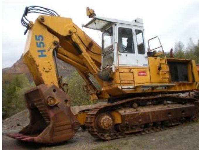
Slika 4.2 Hidraulički bager sa visinskom lopatom [14].
