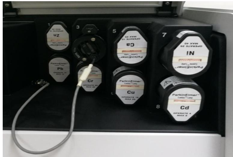
**Slika 8.** Šuplje katodne lampe korištene kao izvor svjetla
