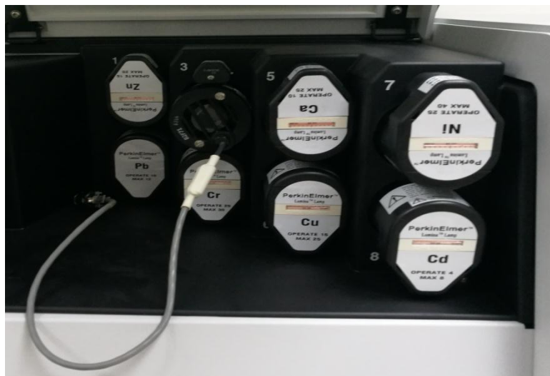
Slika 8. Šuplje katodne lampe korištene kao izvor svjetla
