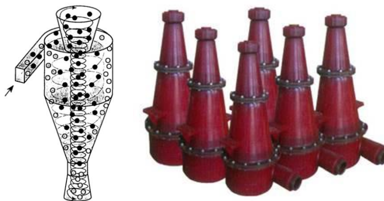
Slika 17. Prikaz principa rada hidrociklona i hidrociklona za razdvajanje smjesa s polimerima [34]
