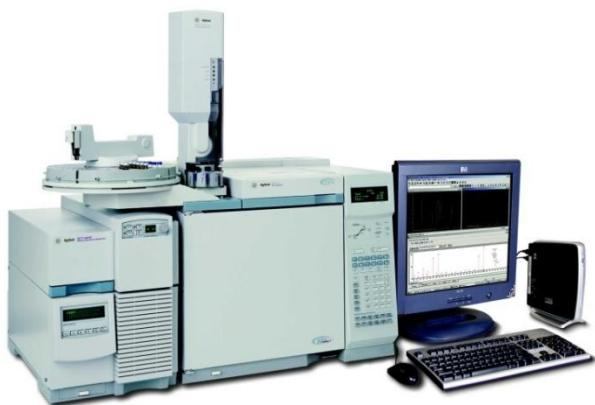
**Slika 6.** Uzorkovanje onečišćiva iz zraka GC-MS analizom
