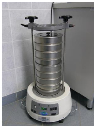
Slika 8. Niz standardnih sita pričvršćenih na tresalicu [5]
