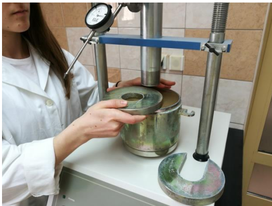
Slika 33. Priprema uzorka za izvođenje CBR pokusa
