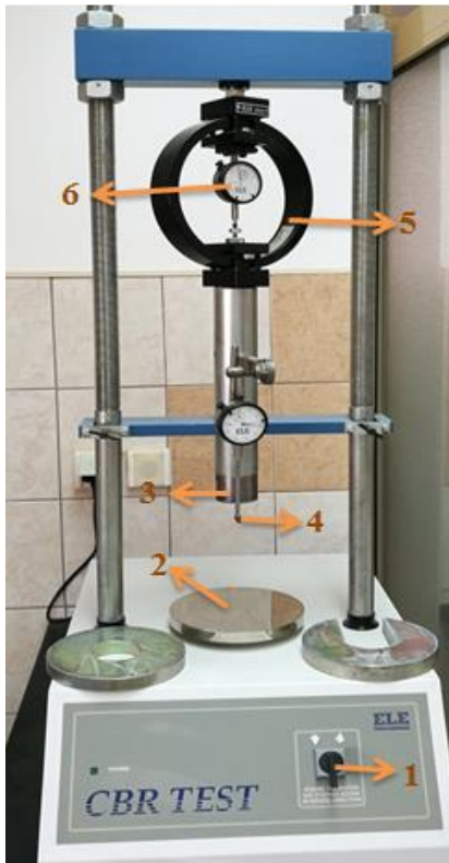
Slika 16. Uređaj za CBR pokus u laboratoriju
