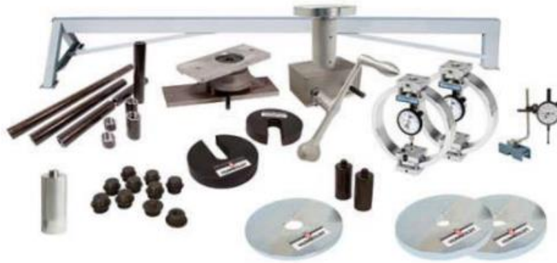
Slika 17. Oprema za CBR pokus na terenu [6]
