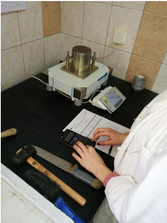
Slika 24. Vaganje zbijenog uzorka tla s kalupom
