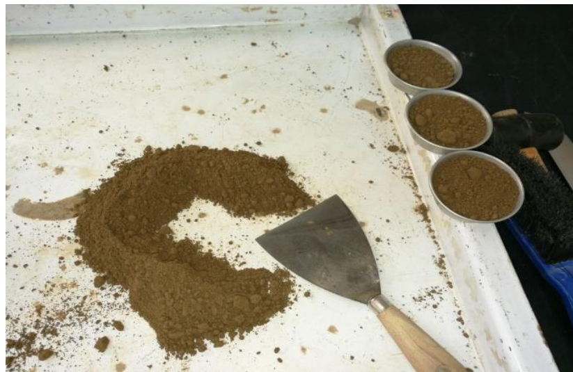
Slika 26. Uzimanje uzorka za određivanje vlažnosti
