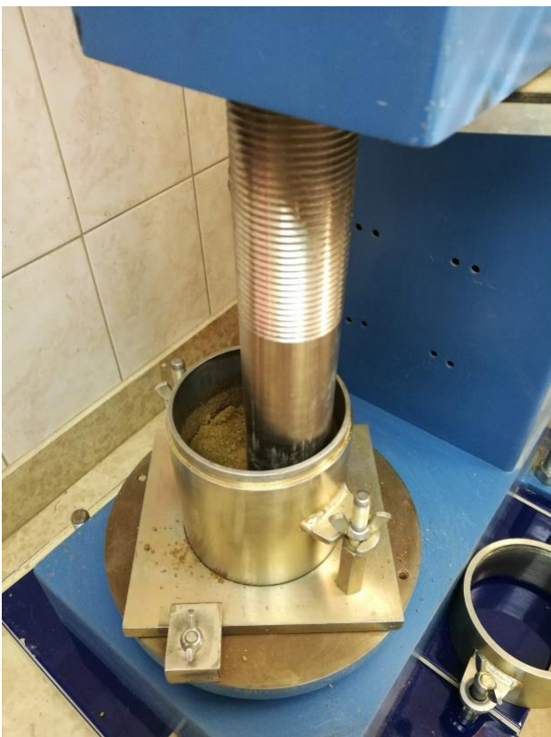
Slika 22. Zbijanje uzorka tla
