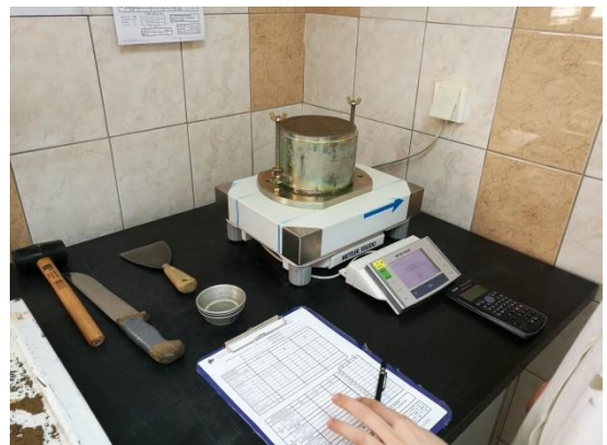
Slika 31. Vaganje zbijenog uzorka tla s cilindričnim kalupom
