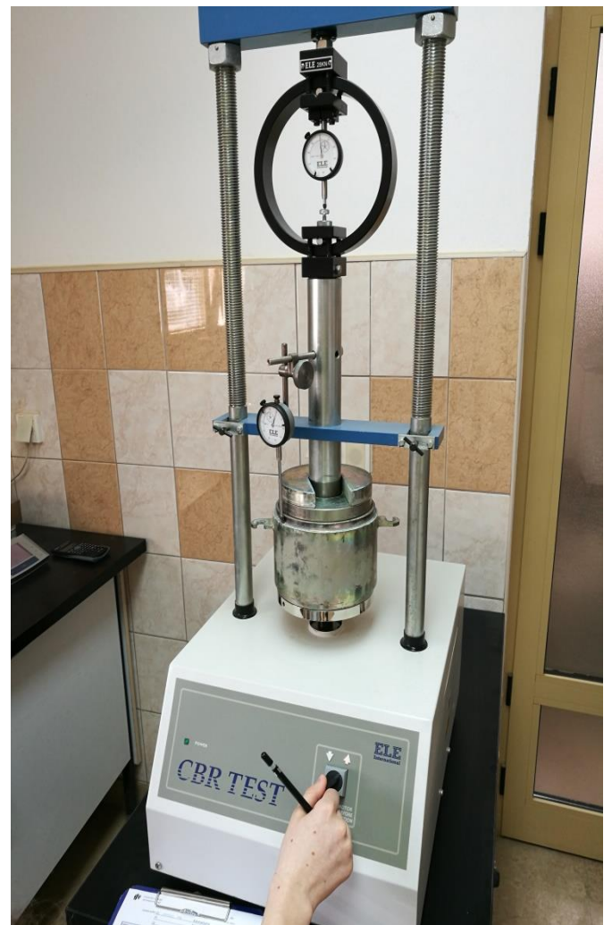
Slika 34. Izvođenje CBR pokusa
