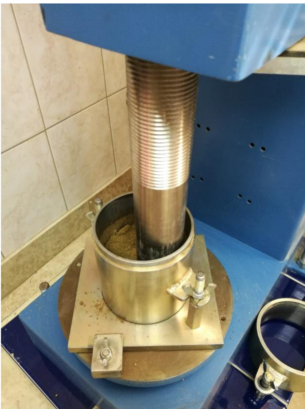
Slika 22. Zbijanje uzorka tla
