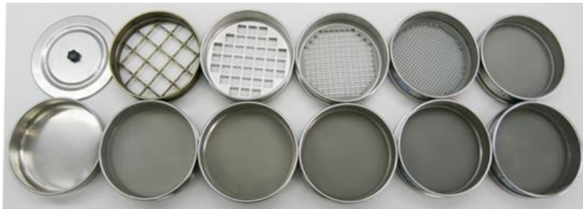
Slika 7. Vrsta sita s obzirom na vrstu otvora [5]
