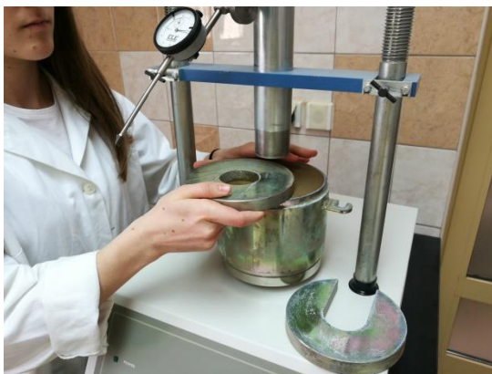
Slika 33. Priprema uzorka za izvođenje CBR pokusa
