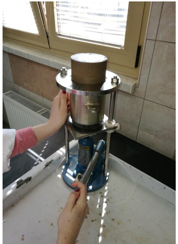
Slika 25. Vađenje zbijenog uzorka tla iz kalupa
