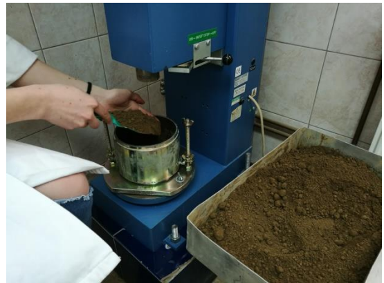
Slika 29. Punjenje cilindričnog kalupa uzorkom tla
