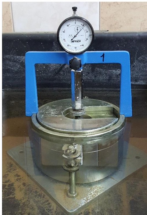
Slika 32. Potapanje uzorka u vodu
