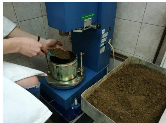
Slika 29. Punjenje cilindričnog kalupa uzorkom tla
