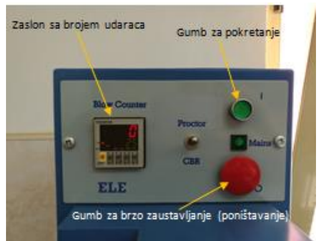
Slika 14. Kontrolna ploča na Proctor-ovom uređaju
