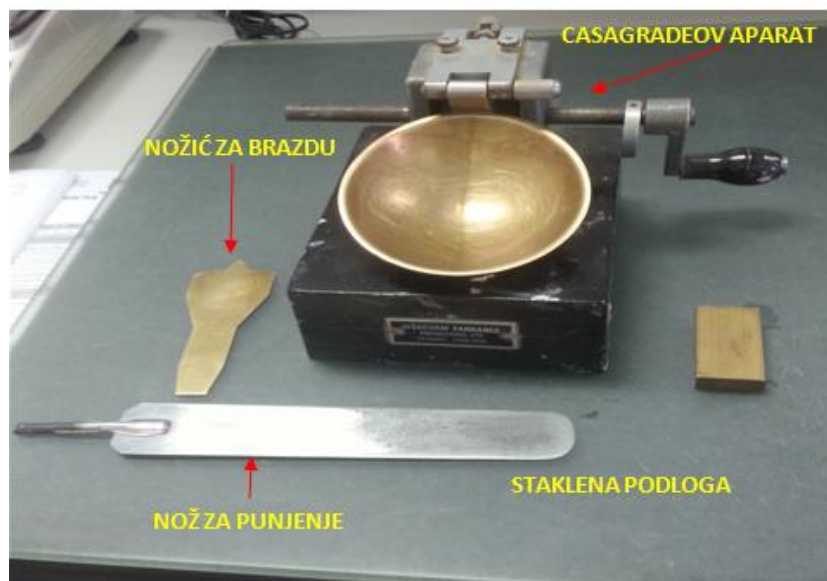
Slika 14. Dio opreme za određivanje granice tečenja Casagrande – ovim aparatom
