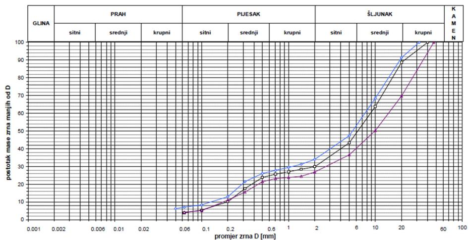
Slika 19. Granulometrijski dijagram i rezultati laboratorijskog ispitivanja uzorka bušotine B-4
