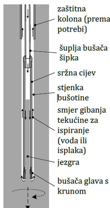
Slika 3. Bušenje s jezgrovanjem, jezgrovanje s jednostrukom jezgrenom (sržnom) cijevi
