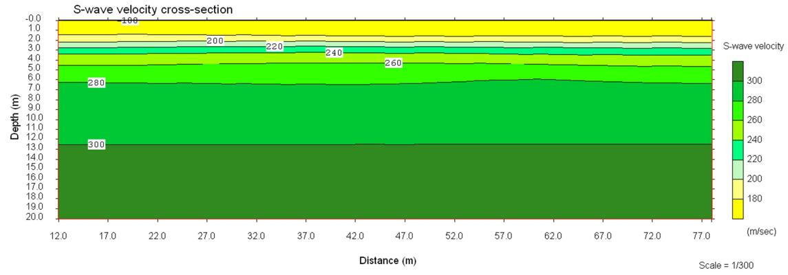
Slika 25b. 2D profil brzine posmičnih seizmičkih valova ( $V_s$ ) izmjerena na MASW-2
