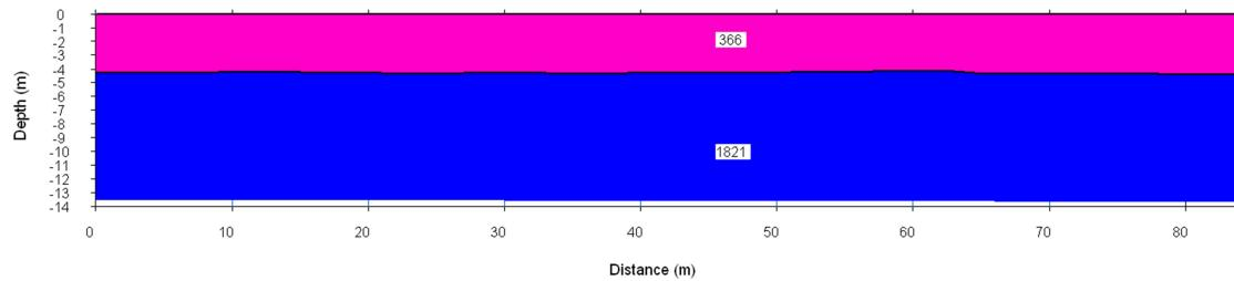
Slika 24a. 2D profil brzine kompresijskih seizmičkih valova izmjerena na RF-1
