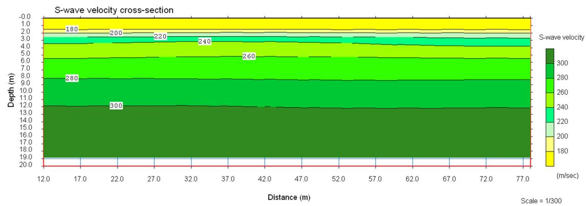
Slika 25a. 2D profil brzine posmičnih seizmičkih valova ( $V_s$ ) izmjerena na MASW-1
