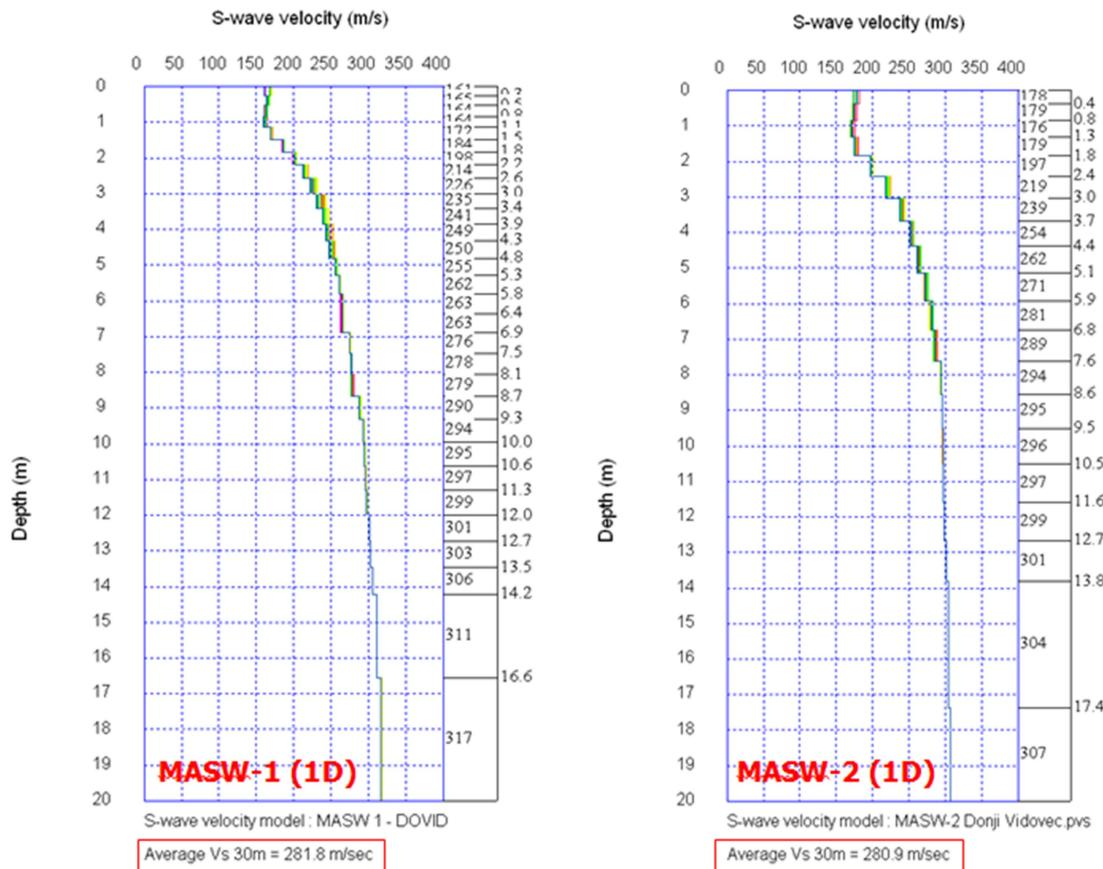
Slika 26. 1D profil brzine posmičnih seizmičkih valova po dubini izmjerena na MASW-1 i MASW-2
