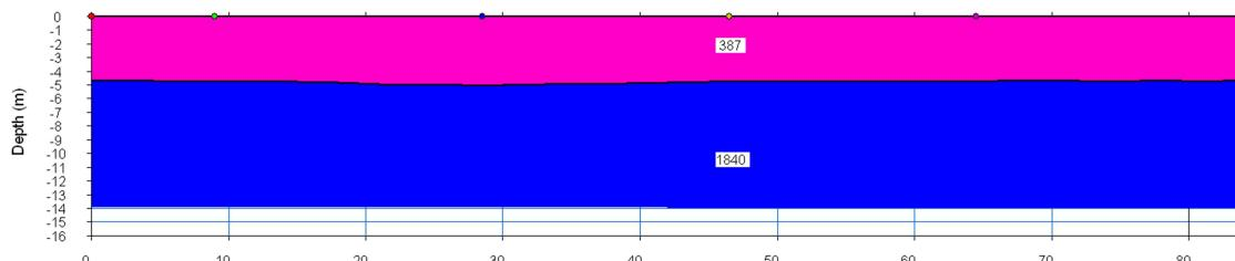
Slika 24b. 2D profil brzine kompresijskih seizmičkih valova izmjerena na RF-3
