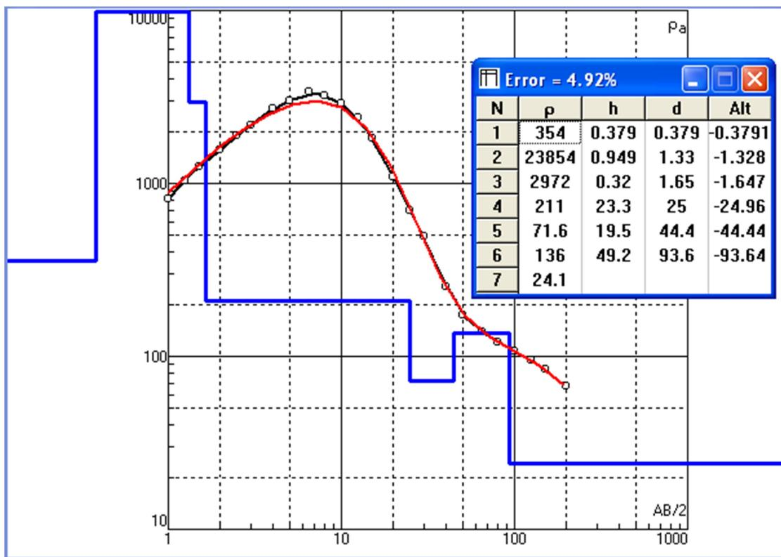
Slika 22. Izmjereni geoelektrični profil na sondi GS-1
