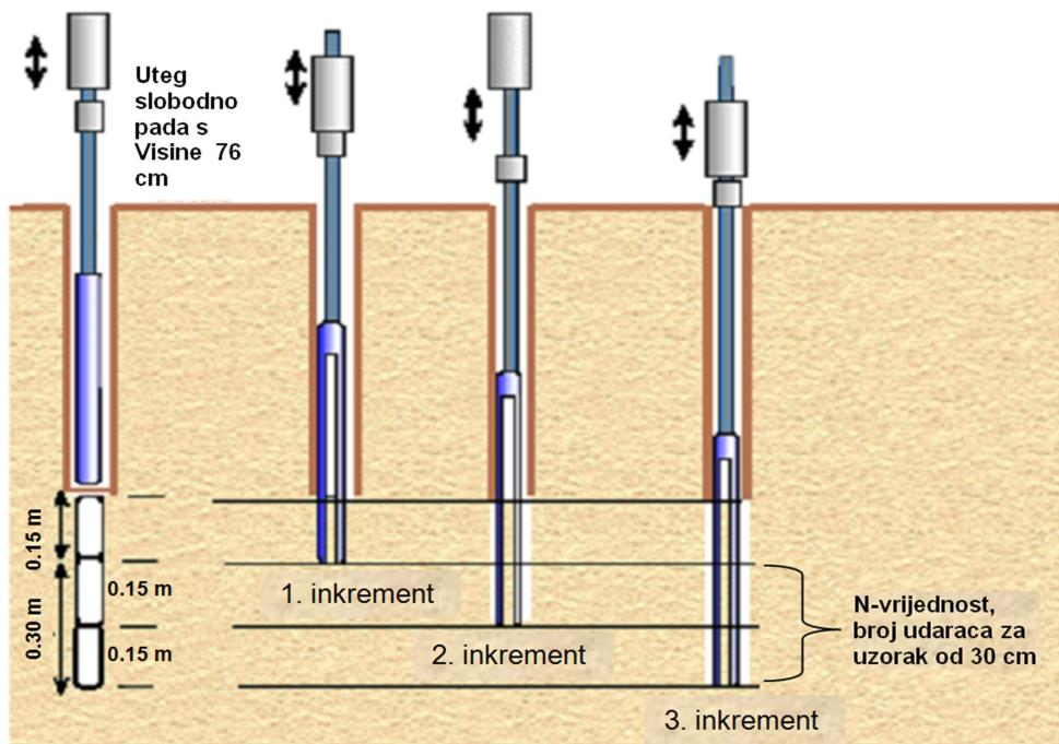
Slika 6. Postupak ispitivanja standardnim penetracijskim pokusom (Roje-Bonacci, 2012)
