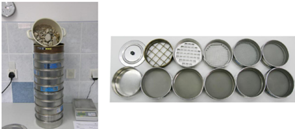
Slika 10. Mehanička tresalica sa odgovarajućim sitima različitih promjera otvora
