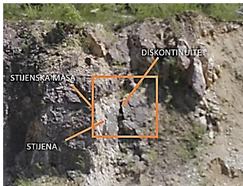
Slika 8. Prikaz diskontinuiteta u stijenskoj masi
