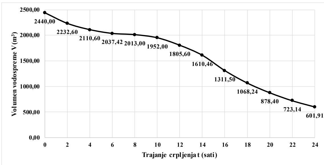
Slika P4-II-21. Promjena volumena vodospreme za početak crpljenja od 20 do 21 sati
