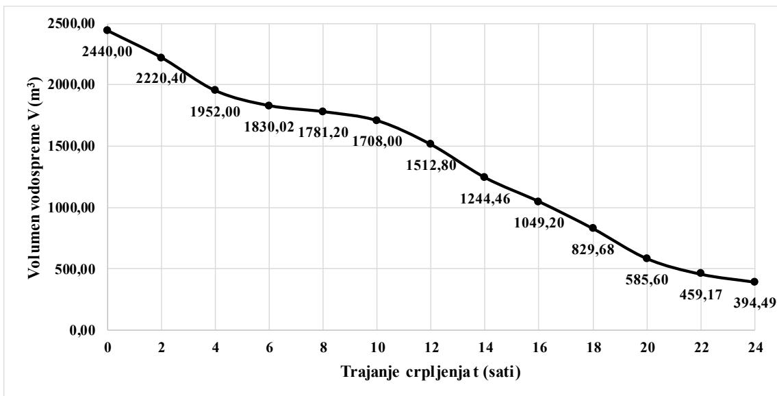
Slika P3-I-19. Promjena volumena vodospreme za početak crpljenja od 18 do 19 sati
