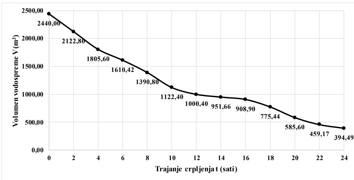
Slika P3-I-13. Promjena volumena vodospreme za početak crpljenja od 12 do 13 sati
