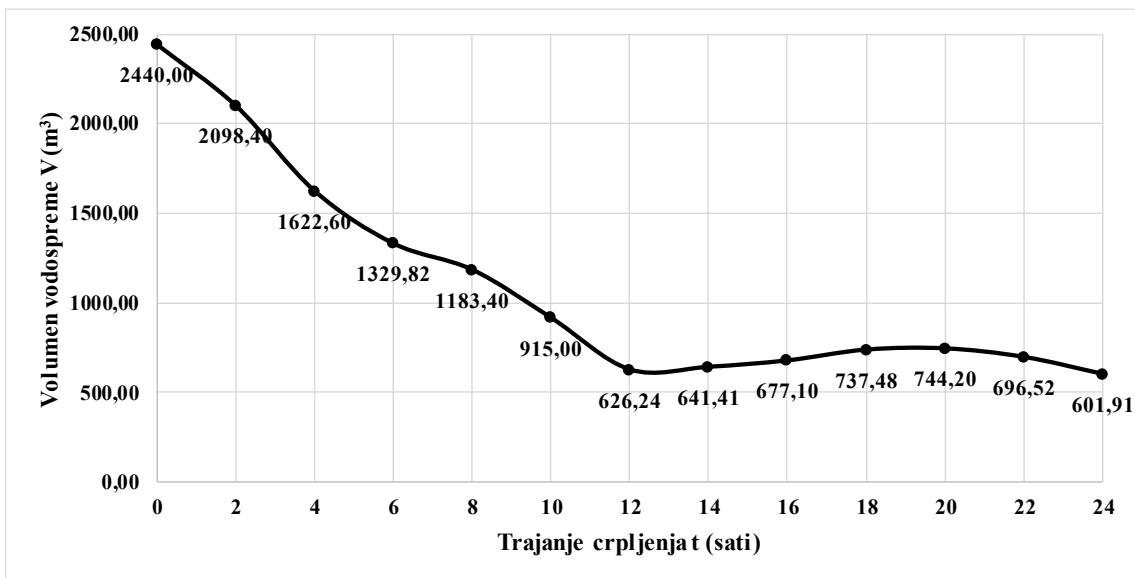
Slika P4-II-11. Promjena volumena vodospreme za početak crpljenja od 10 do 11 sati
