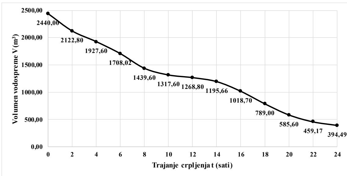
Slika P3-I-15. Promjena volumena vodospreme za početak crpljenja od 14 do 15 sati
