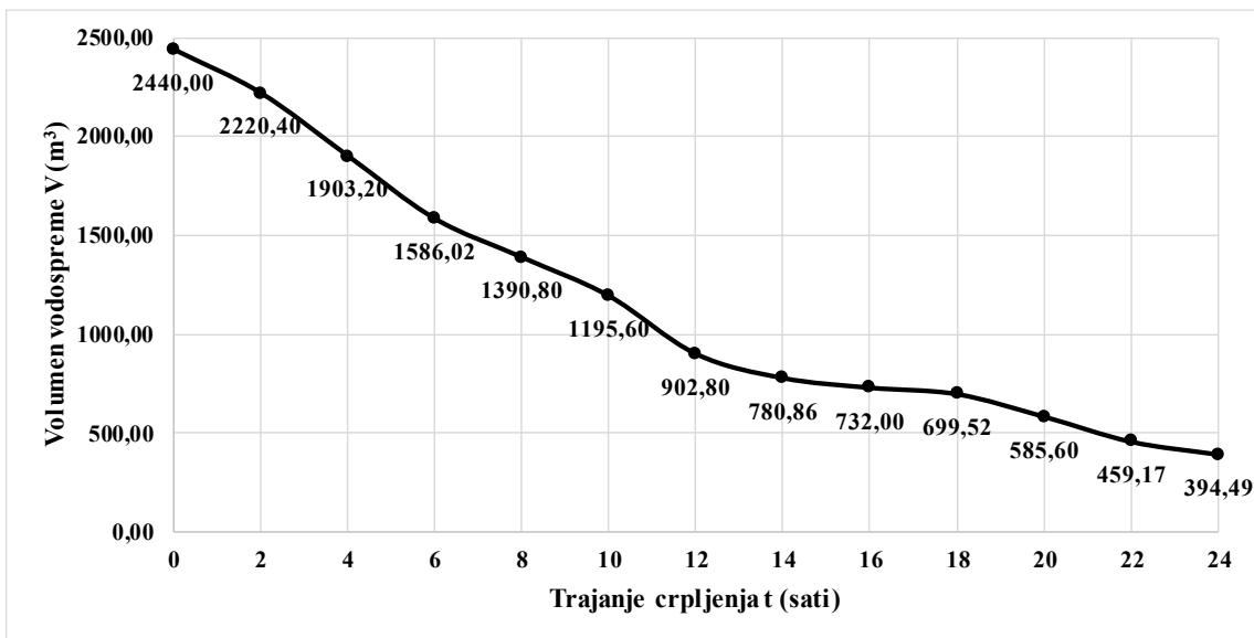
Slika P3-I-11. Promjena volumena vodospreme za početak crpljenja od 10 do 11 sati
