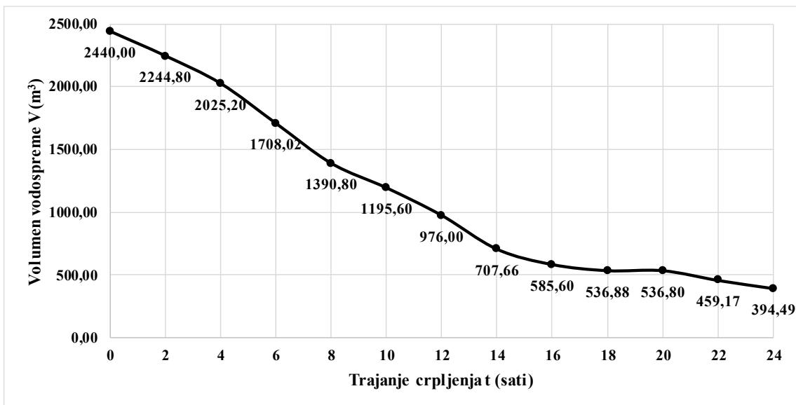
Slika P3-I-9. Promjena volumena vodospreme za početak crpljenja od 8 do 9 sati
