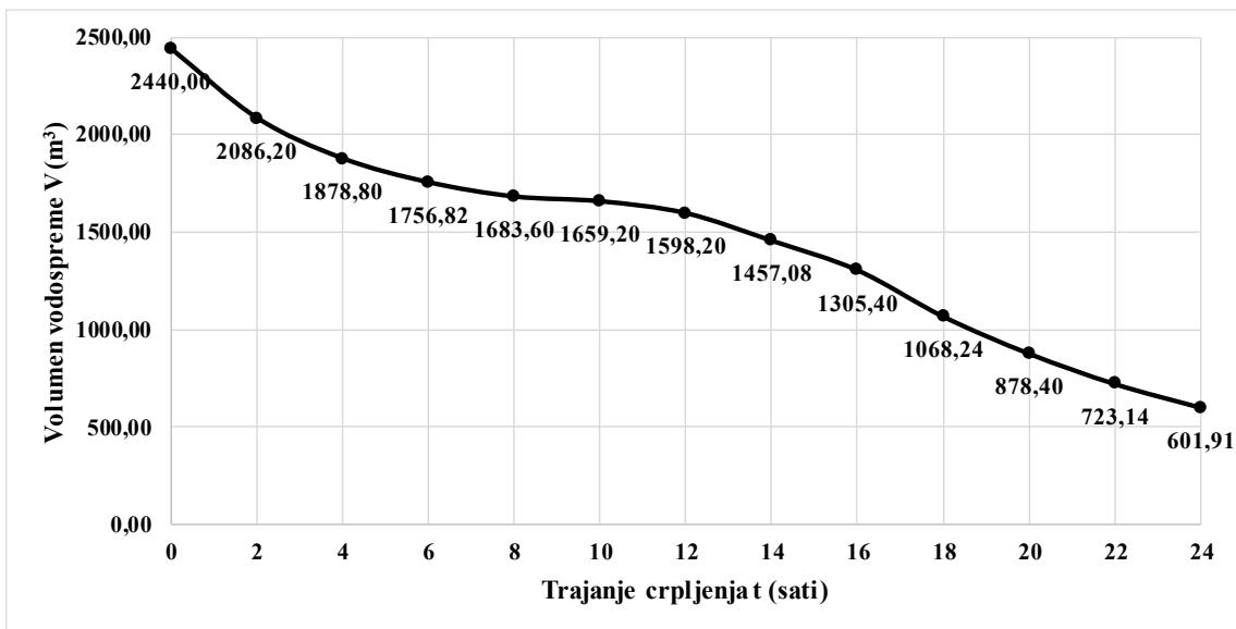
Slika P4-II-19. Promjena volumena vodospreme za početak crpljenja od 18 do 19 sati
