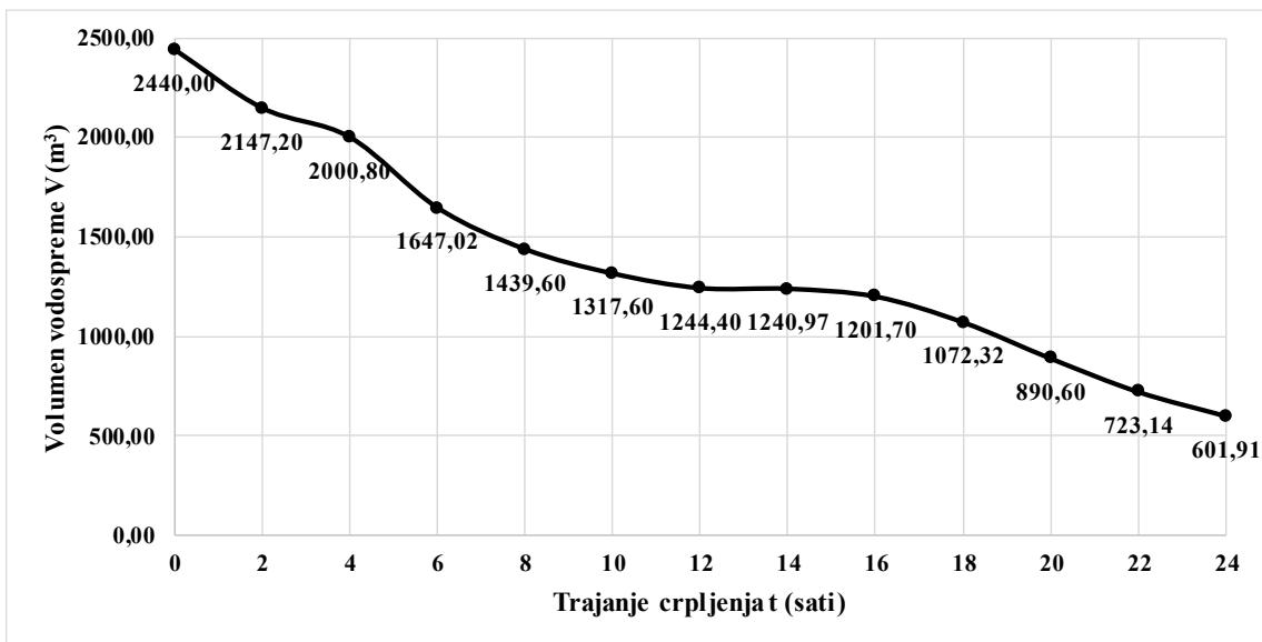
Slika P4-II-15. Promjena volumena vodospreme za početak crpljenja od 14 do 15 sati
