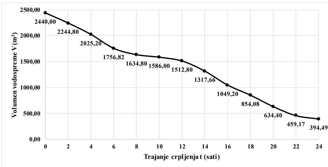
Slika P3-I-17. Promjena volumena vodospreme za početak crpljenja od 16 do 17 sati
