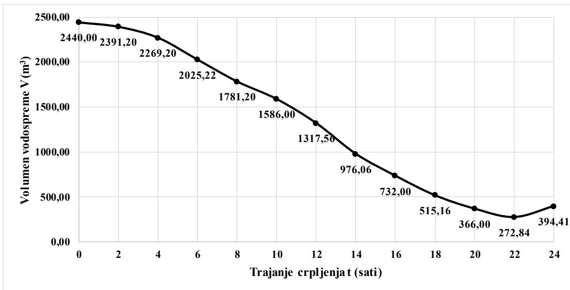
Slika P3-I-3. Promjena volumena vodospreme za početak crpljenja od 2 do 3 sata
