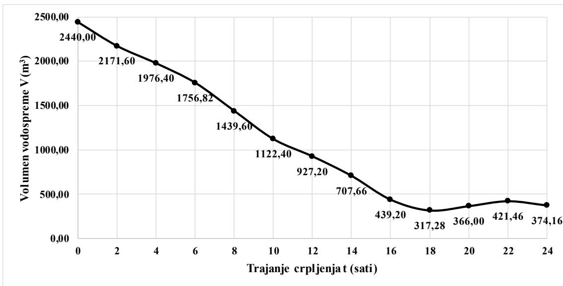
Slika P3-I-7. Promjena volumena vodospreme za početak crpljenja od 6 do 7 sati
