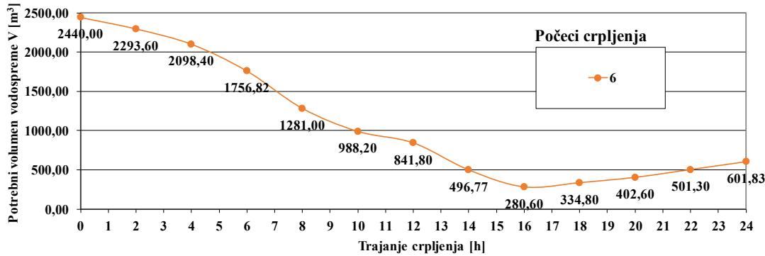
**Slika 19.** Prikaz ovisnosti potrebnog volumena vodospreme o trajanju crpljenja za različiti početak crpljenja za  $Q_{\max}^{dnev} = 2440 \text{ m}^3/\text{dan}$  za ekstrem (minimalnu vrijednost volumena vodospreme) za početak crpljenja u 6 sati s pripadnim trajanjem crpljenja od 16 sati za Varijantu II
