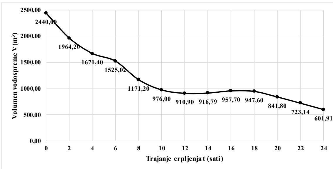
Slika P4-II-13. Promjena volumena vodospreme za početak crpljenja od 12 do 13 sati
