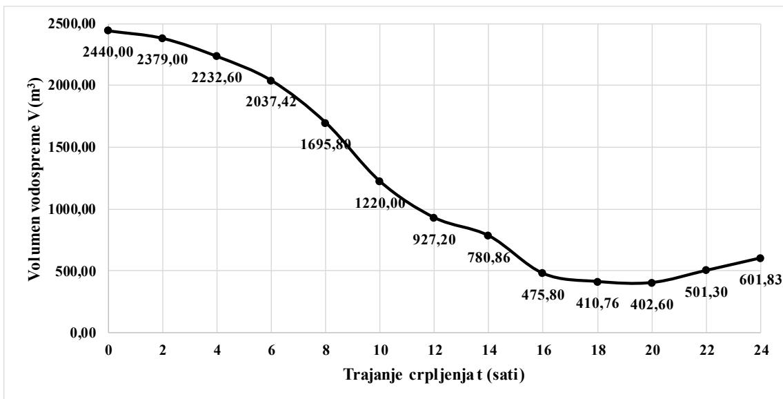
Slika P4-II-5. Promjena volumena vodospreme za početak crpljenja od 4 do 5 sati
