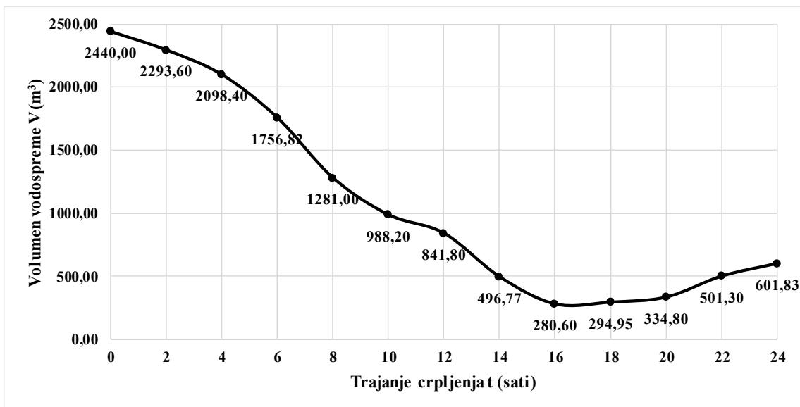
Slika P4-II-7. Promjena volumena vodospreme za početak crpljenja od 6 do 7 sati
