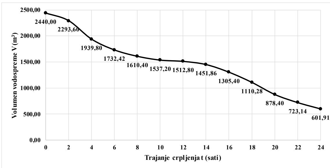
Slika P4-II-17. Promjena volumena vodospreme za početak crpljenja od 16 do 17 sati
