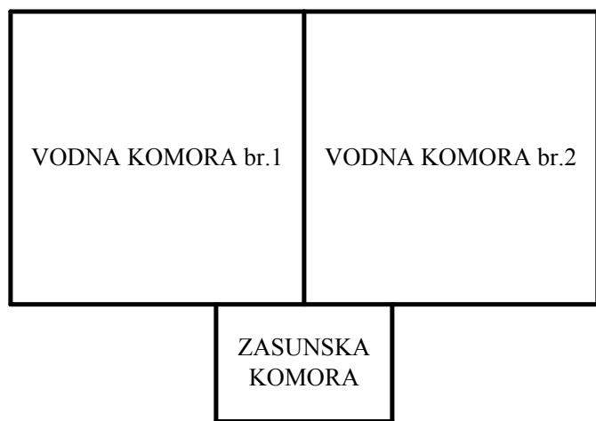
**Slika 4.** Pojednostavljeni prikaz vodospreme i njezinih komora (Margeta, 2011)
