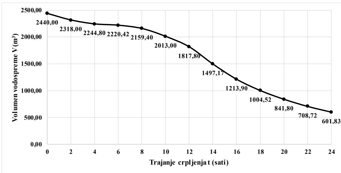
Slika P4-II-23. Promjena volumena vodospreme za početak crpljenja od 22 do 23 sata
