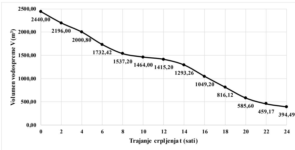
Slika P3-I-16. Promjena volumena vodospreme za početak crpljenja od 15 do 16 sati
