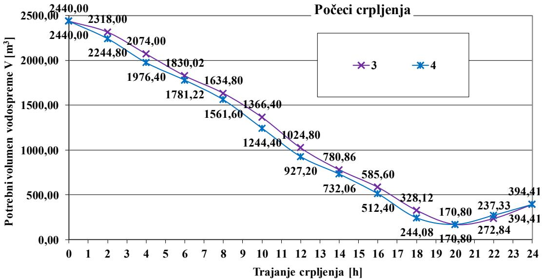
**Slika 17.** Prikaz ovisnosti potrebnog volumena vodospreme o trajanju crpljenja za različiti početak crpljenja za  $Q_{\max}^{dnev} = 2440 \text{ m}^3/\text{dan}$  za ekstreme (minimalne vrijednosti volumena vodospreme) s počecima crpljenja u 3 i 4 sata za Varijantu I
