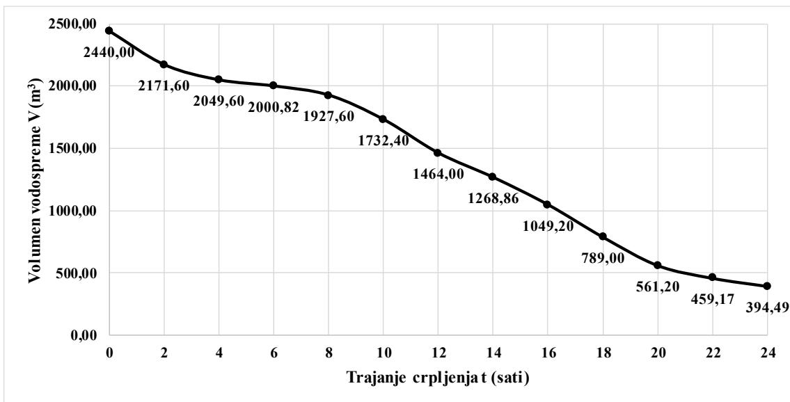
Slika P3-I-21. Promjena volumena vodospreme za početak crpljenja od 20 do 21 sati
