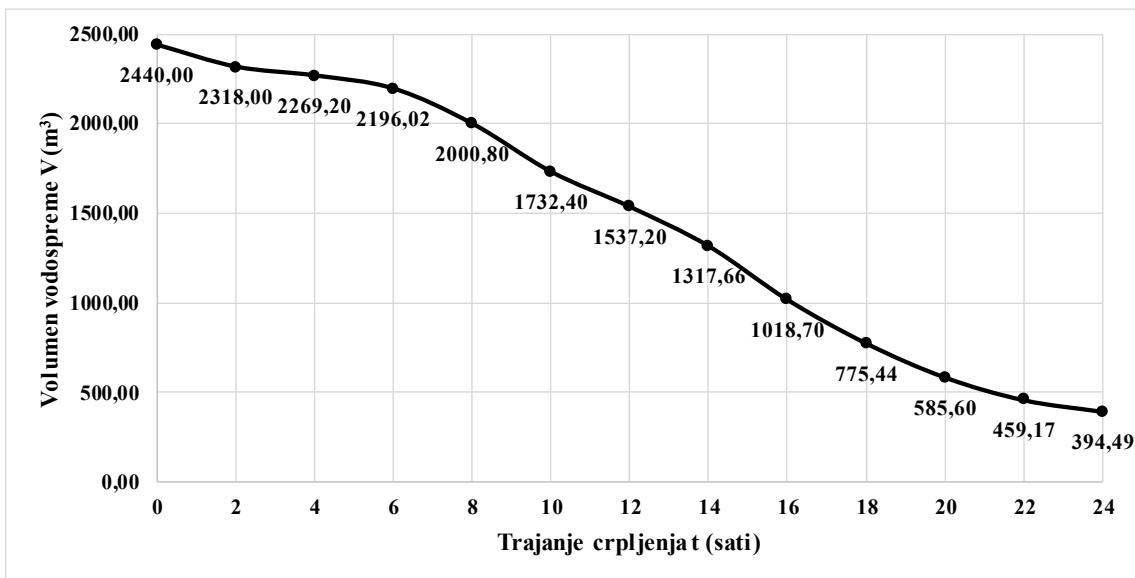
Slika P3-I-23. Promjena volumena vodospreme za početak crpljenja od 22 do 23 sata
