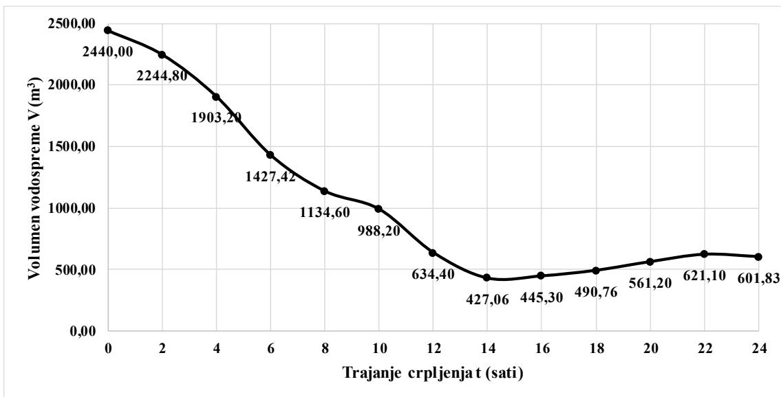
Slika P4-II-9. Promjena volumena vodospreme za početak crpljenja od 8 do 9 sati
