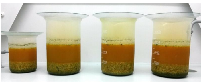
Slika 4. Uzorak LCD – a u zlatotopci nakon 48 sati
