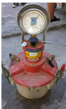
Slika 7. Mjerenje količine zraka u betonu pomoću porometra
