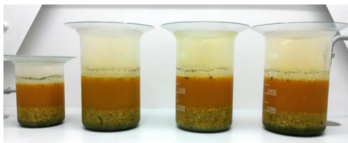
Slika 4. Uzorak LCD – a u zlatotopci nakon 48 sati
