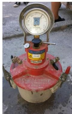
*Slika 7. Mjerenje količine zraka u betonu pomoću porometra*
