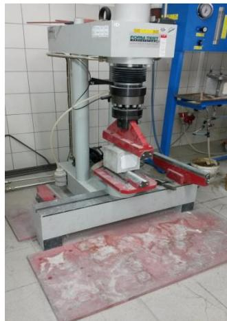
*Slika 10. Ispitivanje vlačne čistoće betona*
