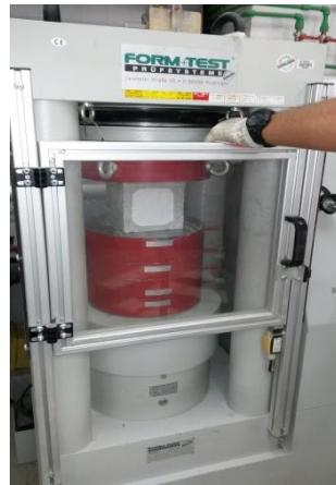
Slika 9. Ispitivanje tlačne čvrstoće betona
