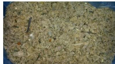
Slika 6. Suh pročišćeni uzorak LCD – a
