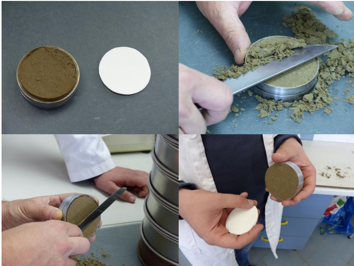
Slika 9. Ugrađivanje uzorka u prsten hidrauličkog edometra
