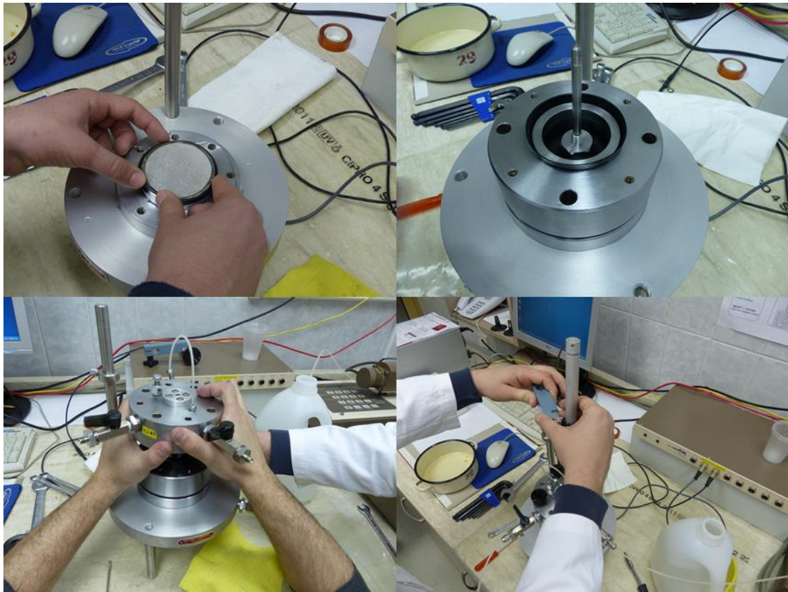
Slika 10. Postupak ugrađivanja uzorka u hidraulički edometar
