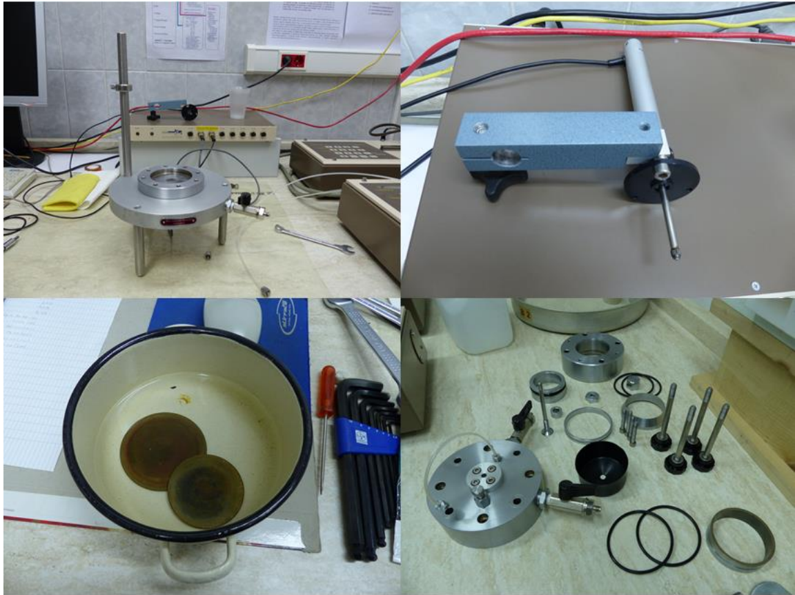
Slika 8. Dijelovi hidrauličkog edometra
