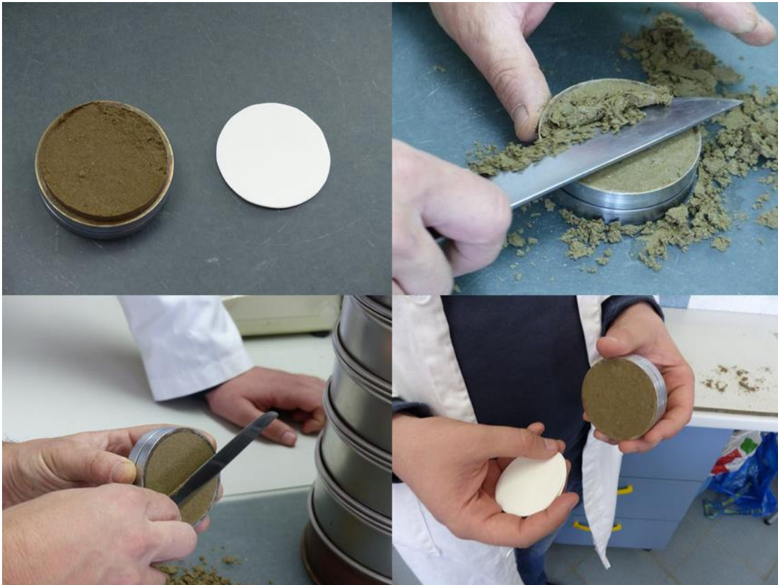
Slika 9. Ugrađivanje uzorka u prsten hidrauličkog edometra
