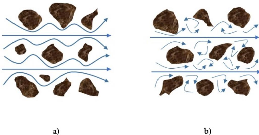
Slika 5. a) Laminarni tok i b) turbulentni tok
