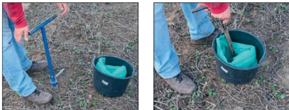
Slika 6. Uzorkovanje pojedinačnog uzorka tla sondom (izvor: [33])
