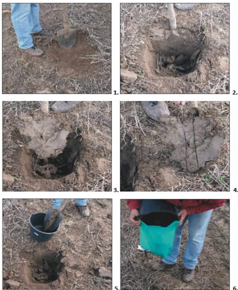
Slika 7. Uzorkovanje pojedinačnog uzorka štihačom (izvor: [33])
