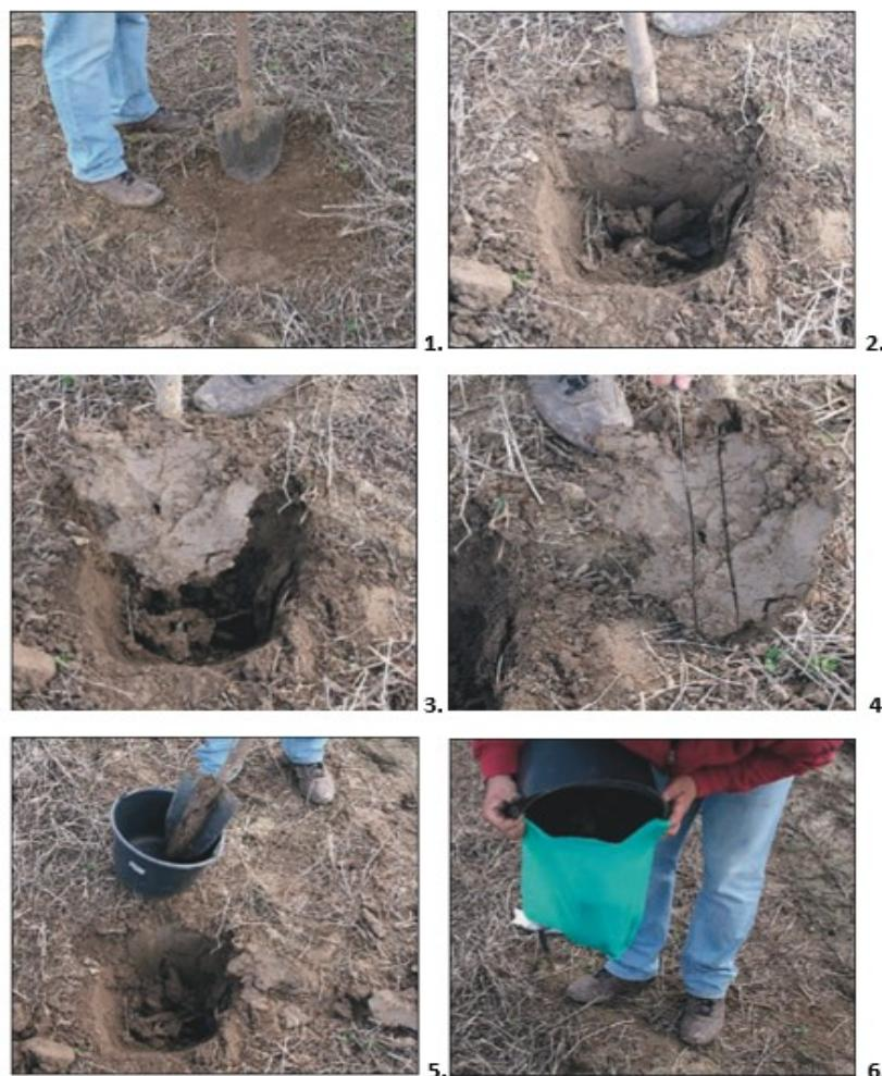
Slika 7. Uzorkovanje pojedinačnog uzorka štihačom (izvor: [33])
