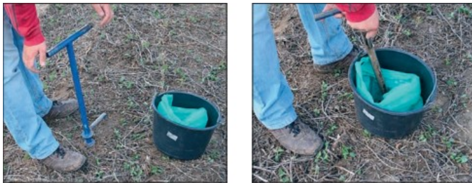
Slika 6. Uzorkovanje pojedinačnog uzorka tla sondom (izvor: [33])
