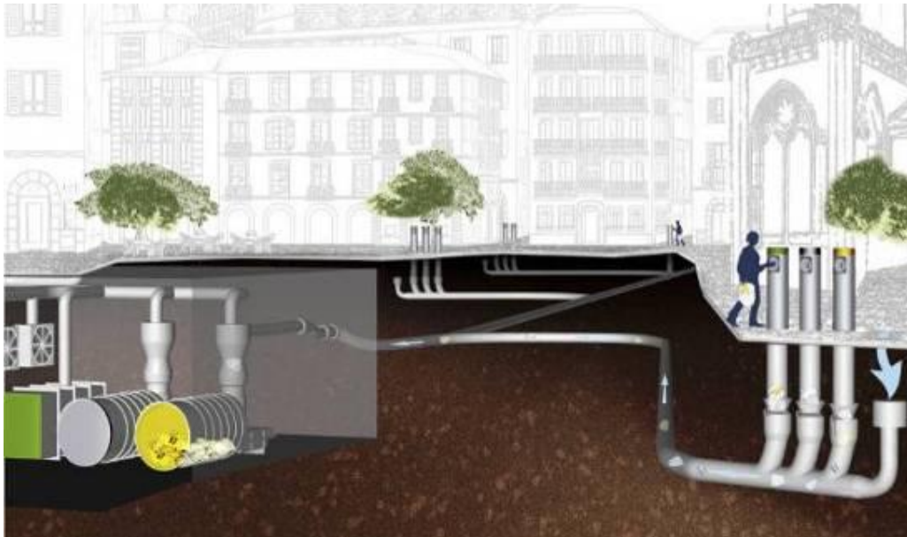
Slika 3 Postrojenje za pneumatsko skupljanje otpada u gradskim centrima [10]
