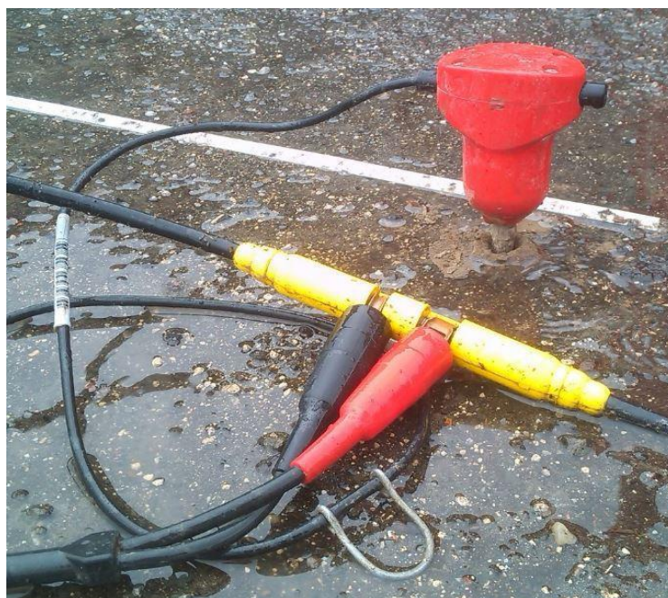
Slika 8 Vertikalni geofon niske frekvencije (4,5 Hz) [3]
