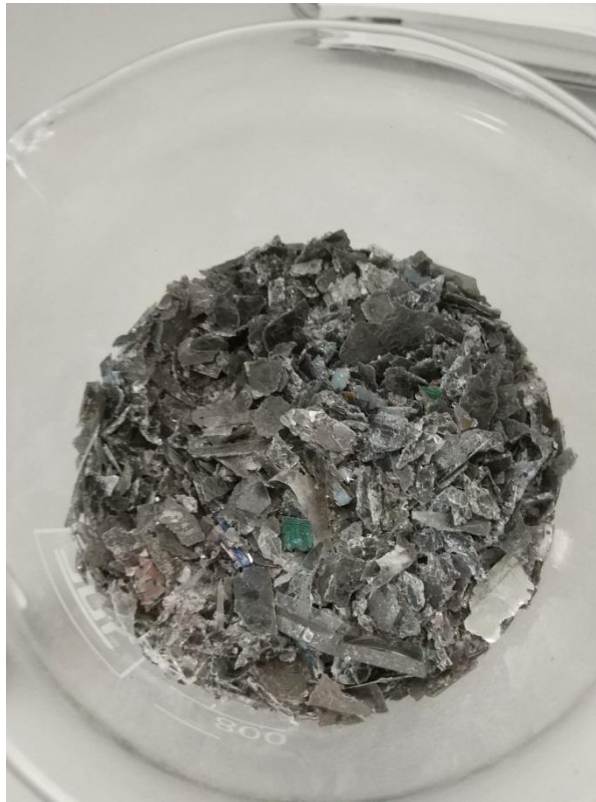
Slika 8. Uzorak usitnjenog LCD-a
