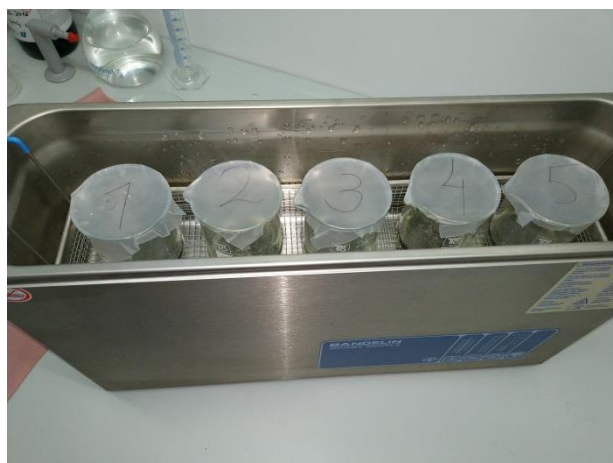
Slika 9. Ultrazvučna kupelj i uzorci
