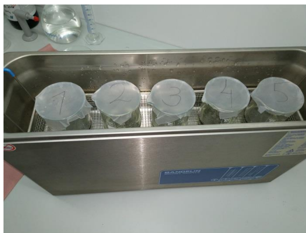
Slika 9. Ultrazvučna kupelj i uzorci
