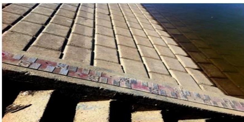
Slika 3. Kosa vodomjerna letva [4]
