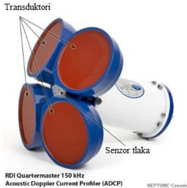
Slika 9. Ultrazvučni uređaj za mjerenje brzine [12]
