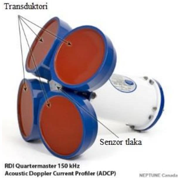
Slika 9. Ultrazvučni uređaj za mjerjenje brzine [12]
