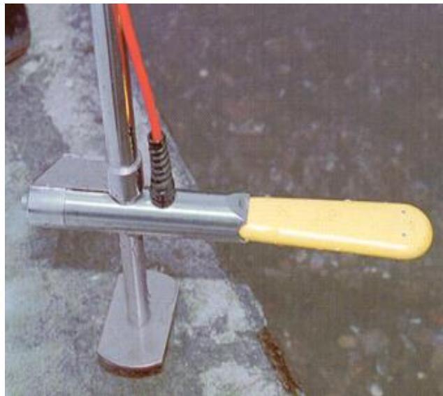
Slika 8. Elektromagnetski mjerač protoka [4]
