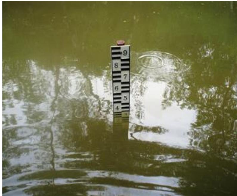
Slika 1. Vodomjerna letva [3]
