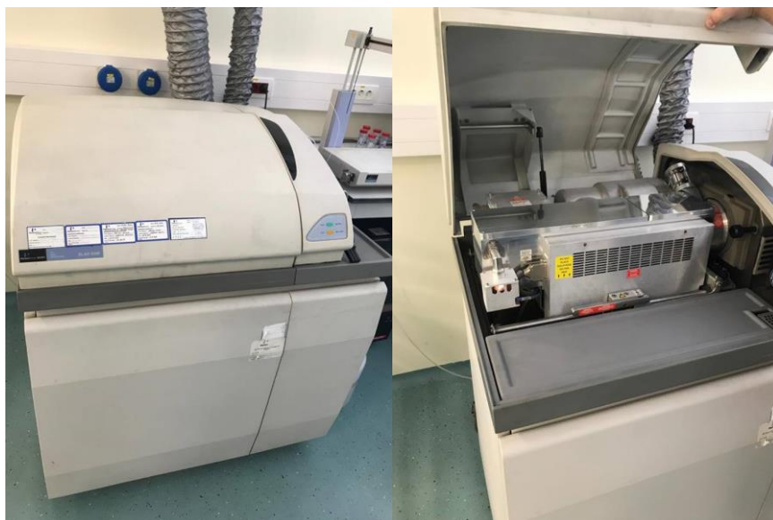
Slika 27. Prikaz uređaja ICP ELAN 9000 iz laboratorija Hrvatskih voda u Zagrebu
