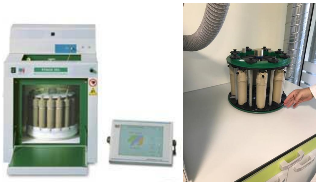
Slika 25. Mikrovalni digestor ETHOS SEL (Milestone)
