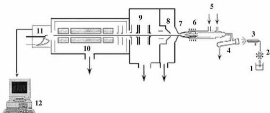
*Slika 26.* Shematski prikaz ICP-MS instrumenta: 1 – tekući uzorak, 2 – pumpa, 3 – raspršivač, 4 – komora za sprejanje, 5 – ulazi za plin argon u baklju, 6 – baklja, 7 – prvi konus (sampler cone), 8 – drugi konus (skimmer cone), 9 – ionske leće, 10 – kvadrupolni maseni analizator, 11 – detektor multiplikator elektrona, 12 – skupljanje podataka [14]
