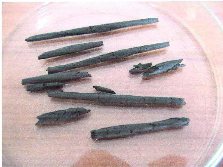
Slika 7. Valjčići za utvrđivanje granice plastičnosti [2]
