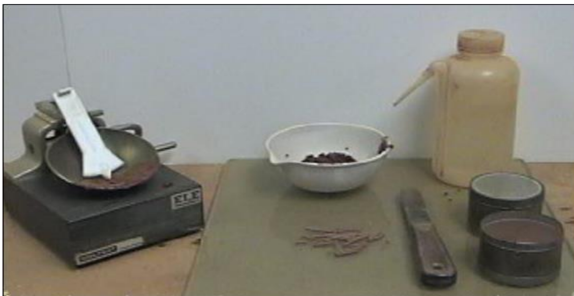
Slika 5. Oprema za utvrđivanje Atterbergovih granica [6]
