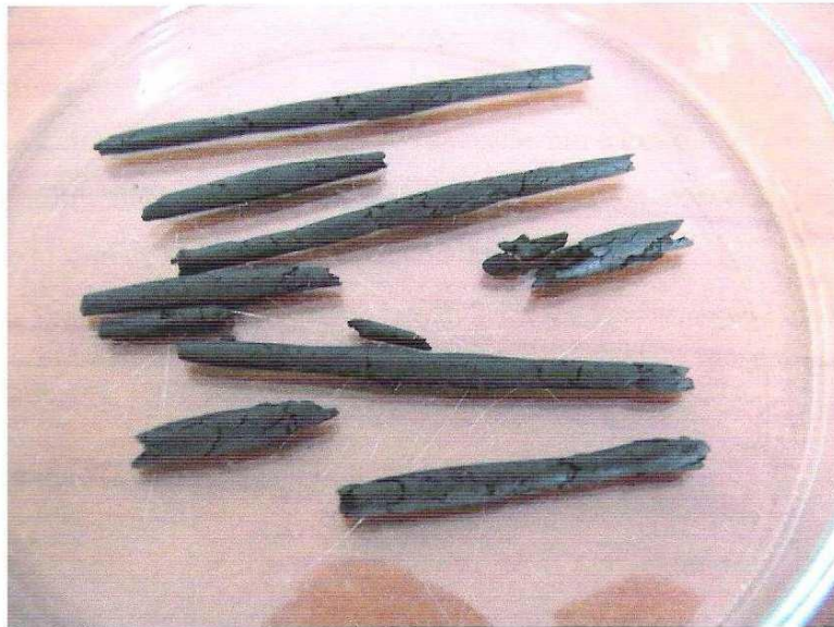
Slika 7. Valjčići za utvrđivanje granice plastičnosti [2]
