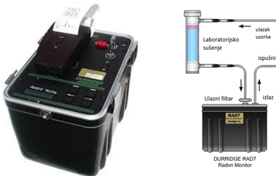
Slika 14. Alfa spektrometar DURRIDGE RAD7 [21]
