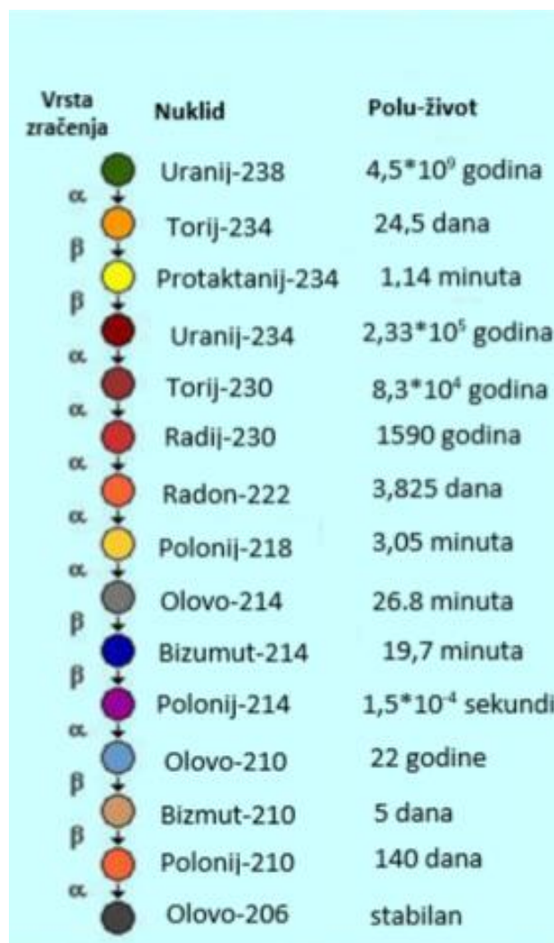
Slika 7. Lanac radioaktivnog raspada ^{238}\text{U} [12]
