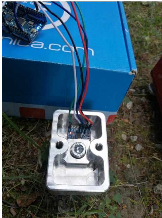
Slika 17. MPU6050 akcelerometar fiksiran u kućištu te spojen na Croduino Basic2 pločicu
