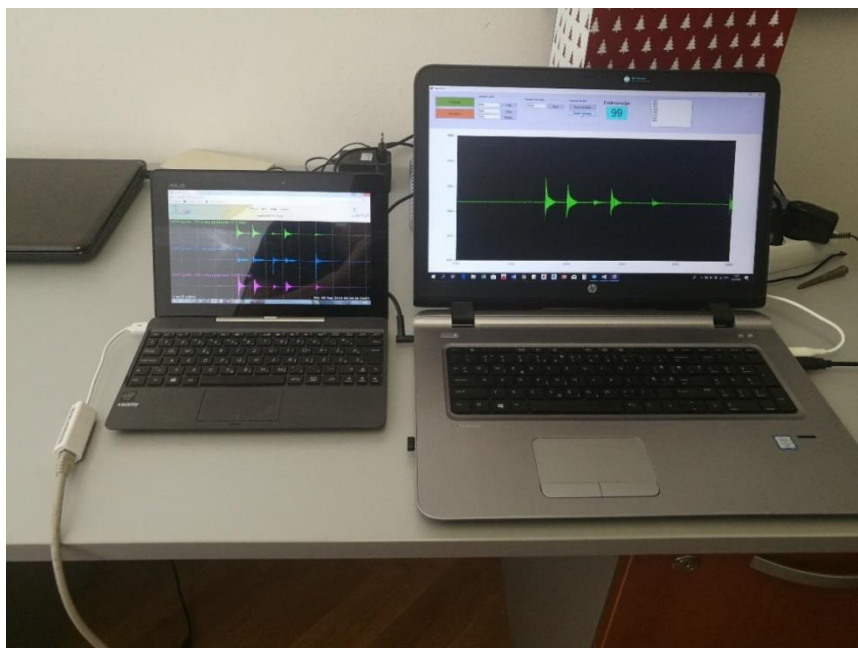
Slika 19. b. Praćenje rezultata snimanja, lijevo Suricat 3D akcelometar (prati se gornja os x), desno Arduino platforma
