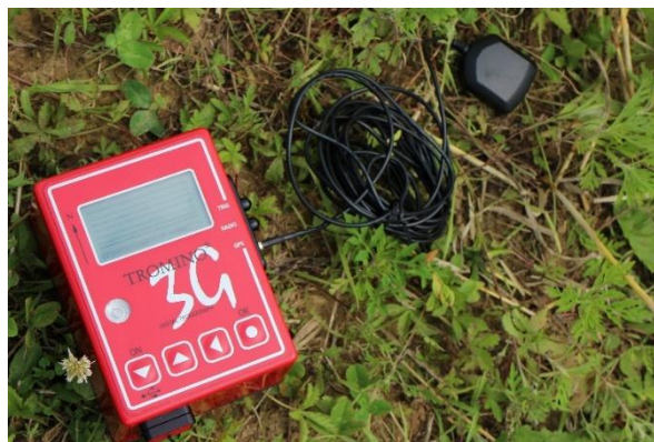
Slika 7. Uređaj za HVSR mjerenja: Tromino Micromed S.p.A., Mogliano Veneto, Italy.
