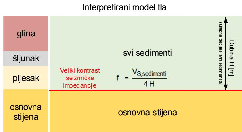
Slika 14. Interpretacija rezonantne frekvencije  $f_0$  na kontaktu osnovne stijene i sedimentnog paketa. Dubina sedimenta H se može odrediti ako je poznata brzina  $V_s$  iz MASW mjerena ili iz refrakcijske seizmike.
