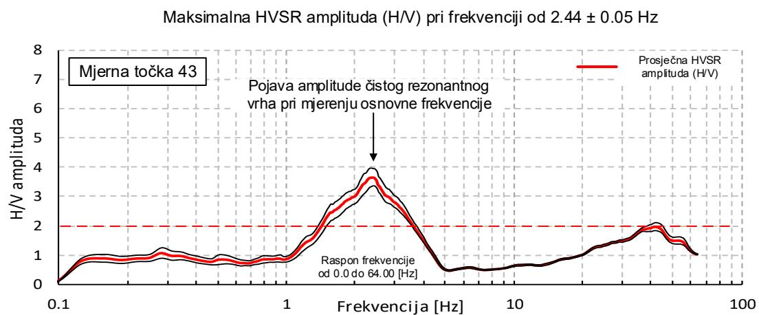
Slika 18. Čisti rezonantni vrh na HVSR krivulji.
