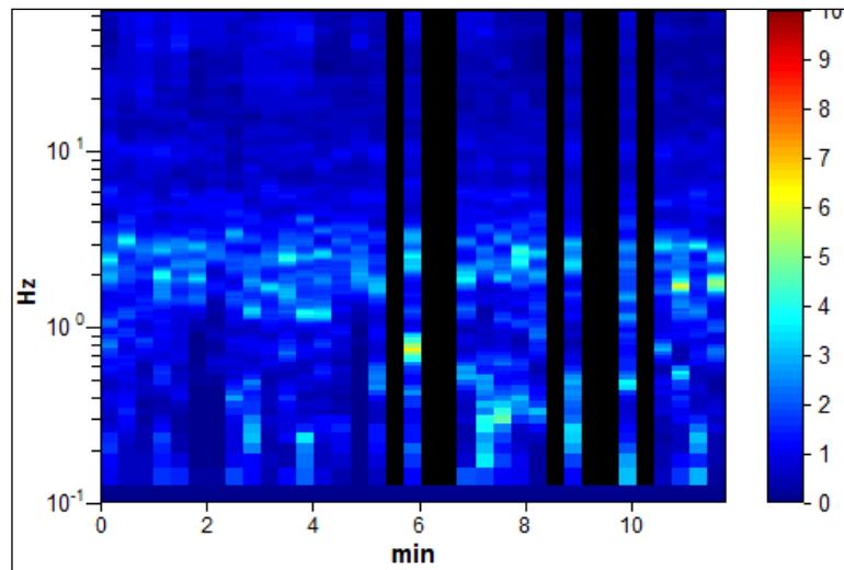
Slika 10. Postupak izoliranja (uklanjanja) vremenskih sekvenci kontaminiranih mjerena.
