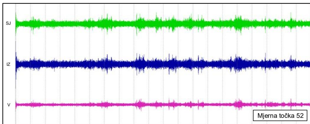
Slika 9. Primjer snimke mikroseizmičkog nemira u trajanju od 20 minuta. Prikazani su zapisi amplituda brzine mikrovibracija u vremenu za glavne komponente: horizontalna S – J (zelena boja), horizontalna I – Z (plava boja) i vertikalna (roza boja).
