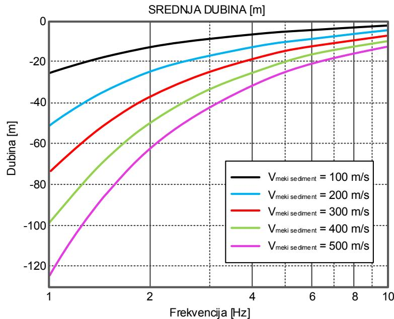
Slika 15. Dijagram promjene debljine  $H$  sedimenata iznad osnovne stijene ovisno o rezonantnoj frekvenciji  $f_0$  za konstantne brzine posmičnih valova  $V_s$ . Osnovni interpretacijski model je dvoslojni, pa postoji samo jedna granica, odnosno kontakt osnovne stijene i nadслоја. U tom slučaju je debljina sedimenata upravo jednaka dubini  $H$  na kojoj se nalazi granica (Magnon, 2013).
