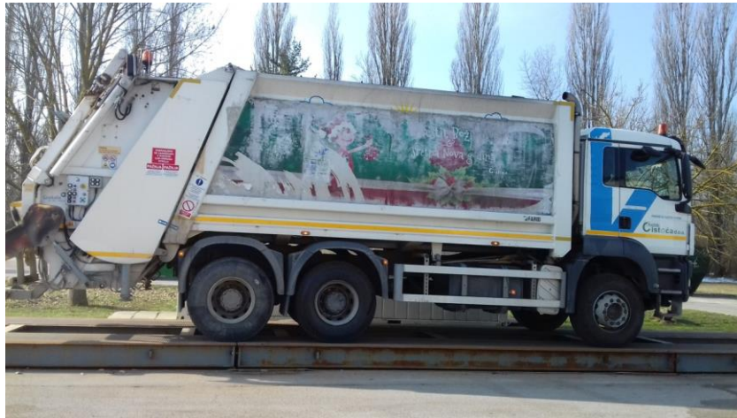
Slika 20 Prikaz kamiona s prikupljenim otpadom na vagi
