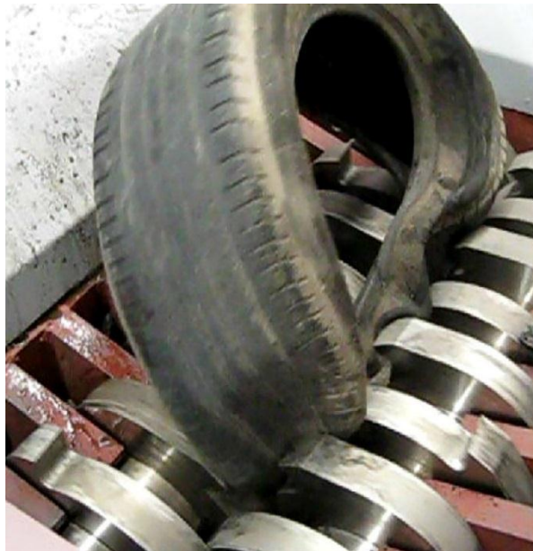
Slika 15. Prikaz usitnjavanja gume u šrederu
