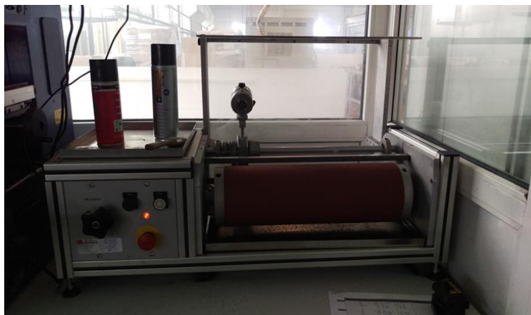
Slika 21. a) uređaj za ispitivanje odbojne elastičnosti, b) uređaj za ispitivanje habanja
