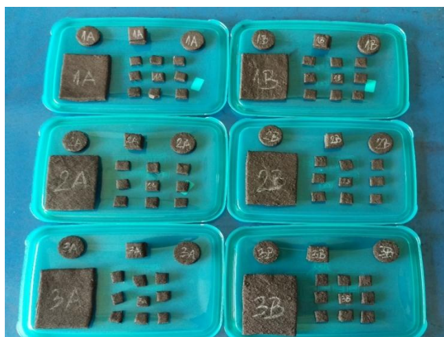
Slika 16. Uzorci mljevene auto gume (1A, 2A, 3A) te mljevene i devulkanizirane auto gume (1B, 2B, 3B)
