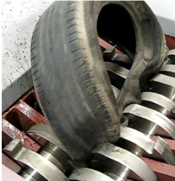
Slika 15. Prikaz usitnjavanja gume u šrederu
