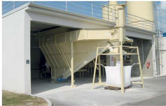
Slika 11. Spremanje solidifikata u tzv. „yumbo“ vreće [11]
