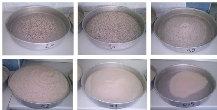
Slika 10. Udjeli pojedinih veličina zrna u ukupnoj masi ispitivanog uzorka
