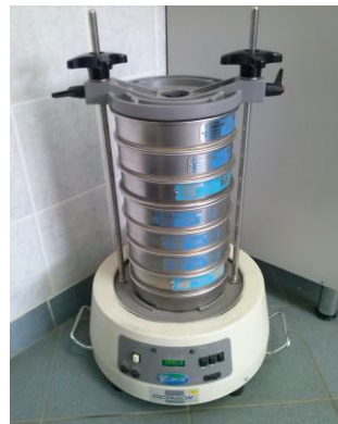
Slika 4. Niz sita pričvršćenih na tresalicu [9]
