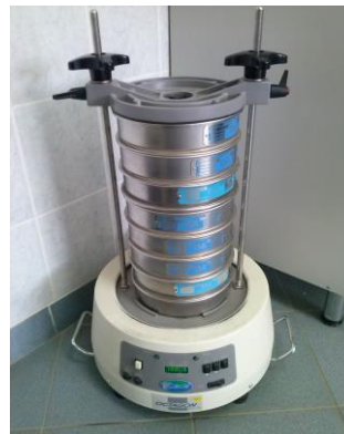
Slika 4. Niz sijača pričvršćenih na tresalicu [9]
