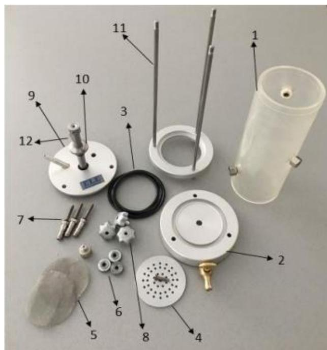
Slika 12. Dijelovi permeametra [17]
