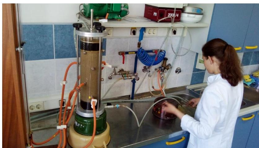
Slika 16. Ispitivanje u permeametu sa stalnim potencijalom
