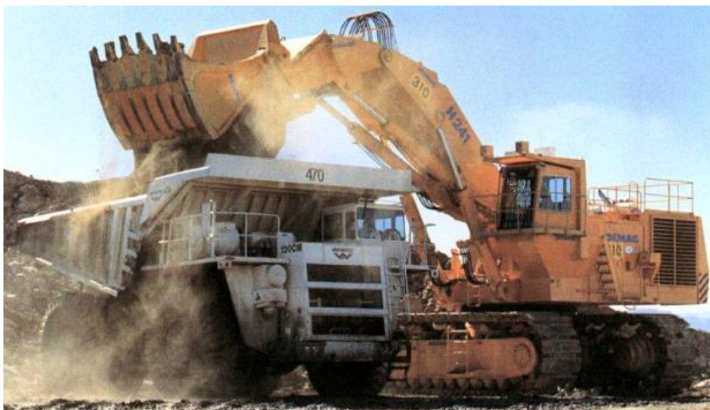
Slika 27 Bager sa visinskom lopatom [39]
