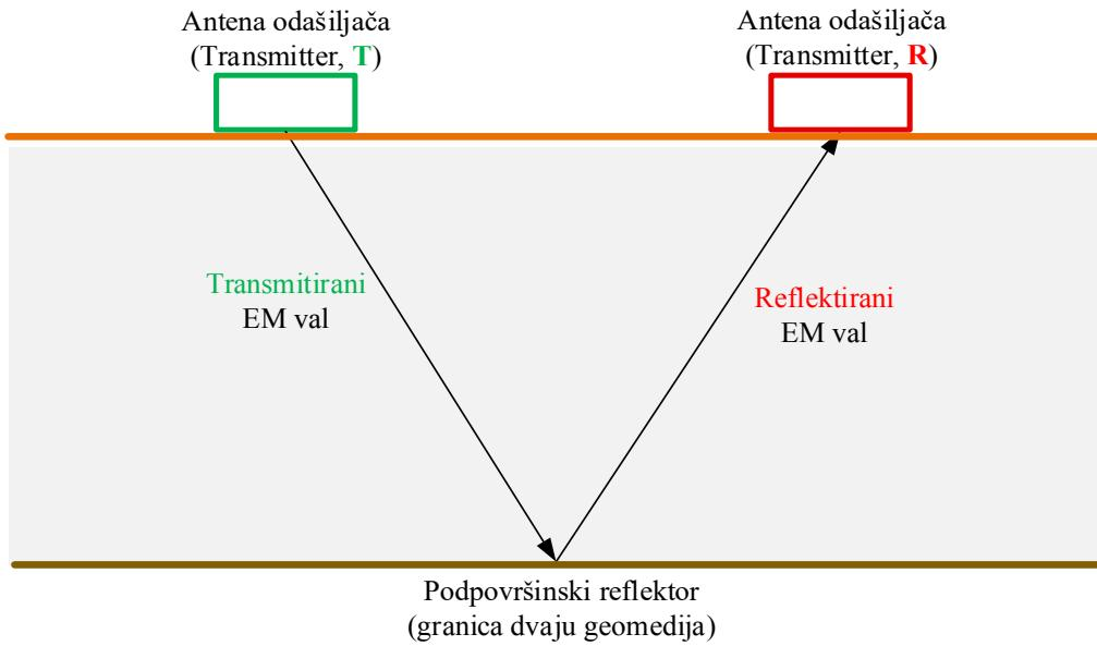
Slika 1. Princip rada georadara (Izvor: Robinson i dr., 2013).
