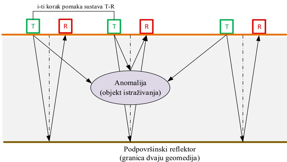
Slika 2. Princip rada georadara odbijanjem od anomalije (Izvor: Robinson i dr., 2013).
