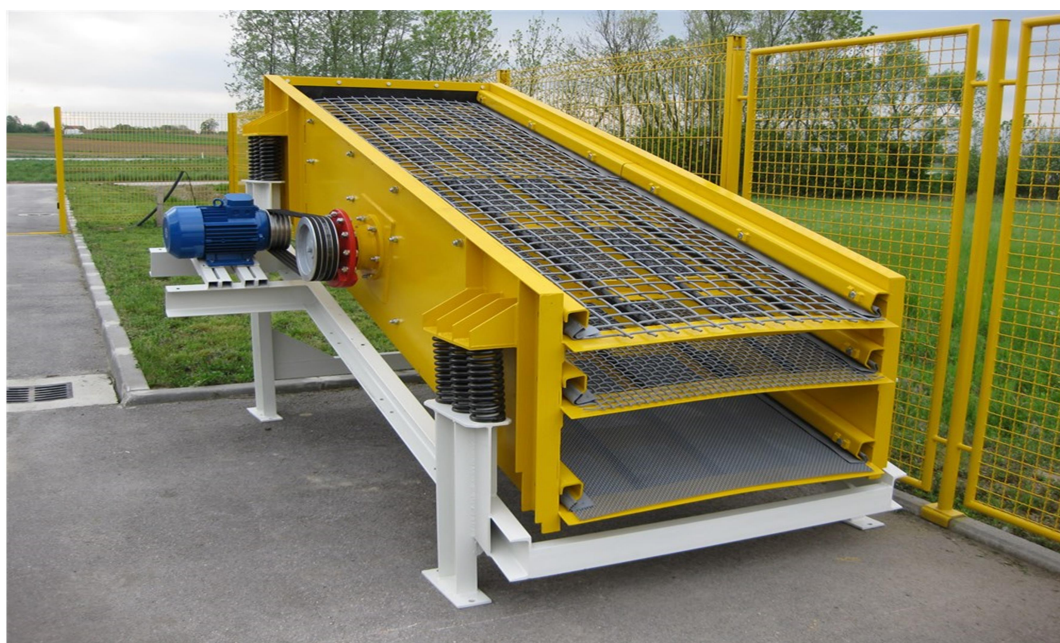
Slika 10. Vibracijsko troetažno sito [10]
