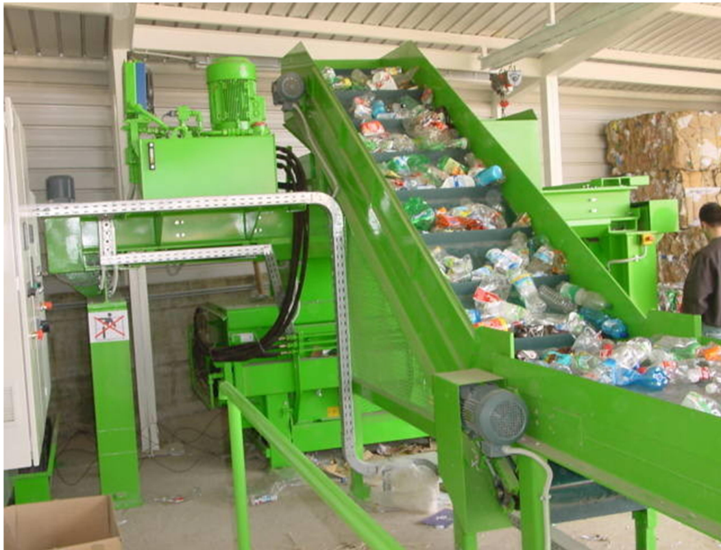
Slika 15. Stroj za sortiranje komunalnog otpada [13]
