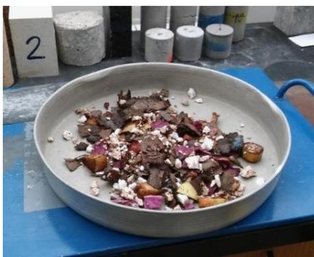
Slika 13. Dio uzorka za ispitivanje vlažnosti – prije sušenja
