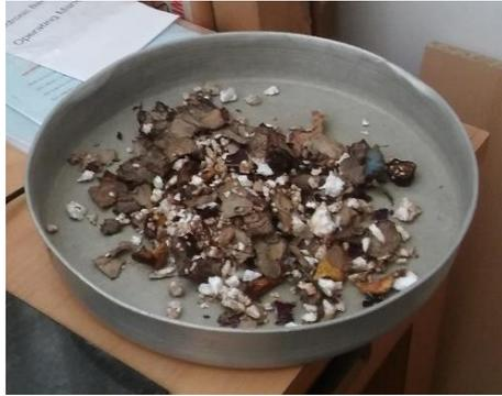
Slika 14. Dio uzorka za ispitivanje vlažnosti – nakon sušenja
