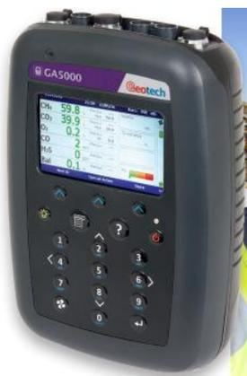
Slika 5. Instrument za mjerenje odlagališnih plinova [16]
