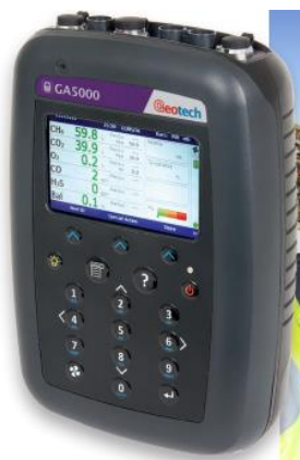
Slika 5. Instrument za mjerenje odlagališnih plinova [16]
