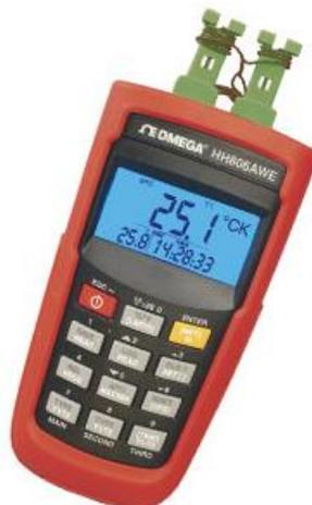
Slika 4. Temperaturni senzor OMEGA HH806AWE [15]
