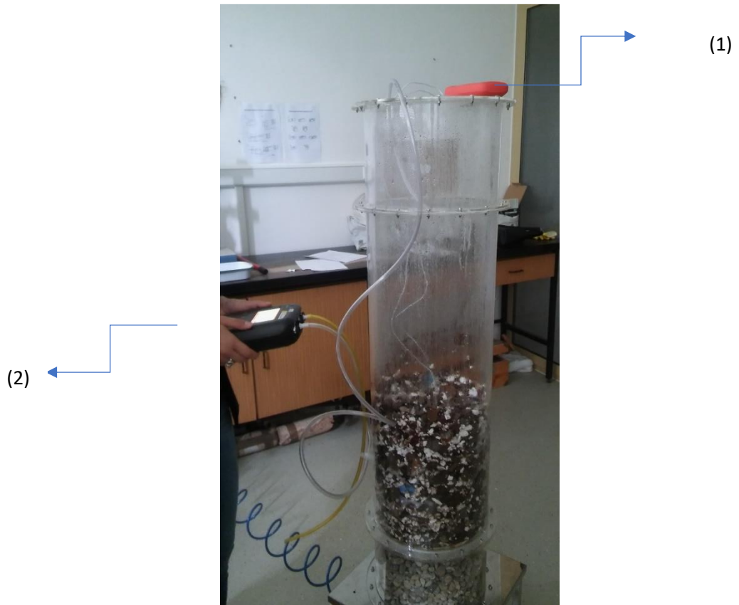
Slika 16. Uređaj za mjerenje temperature (1) i za mjerenje plinova (2)
